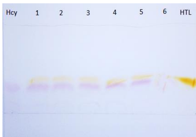
Obrázek 17: Fotografie HPTLC destičky s vyvinutým chromatogramem s první úspěšnou konverzí homocysteinu na jeho thiolakton, homocystein a homocystein thiolakton jsou standardy s koncentrací 500 \mu\text{mol.l}^{-1}
