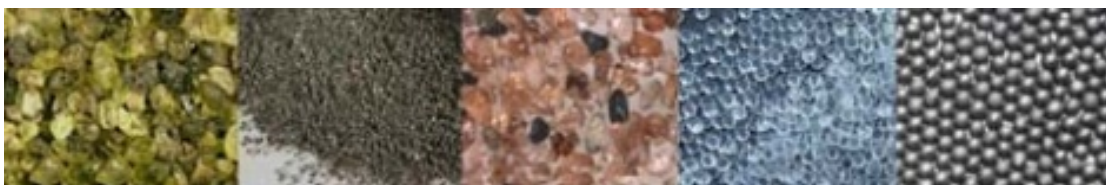
Obr. 2.6 Druhy abrazivního materiálu (zleva: olivín, oxid hlinitý, granát, skleněné kuličky a ocelové kuličky) [20].
