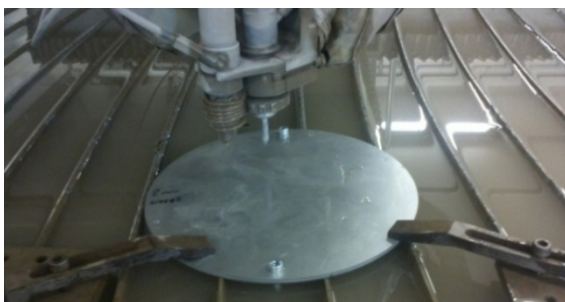
Obr. 4.14 Upnutí dvou polotovarů.
