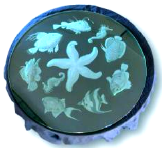
Obr. 1.8 Gravírování reliéfů do skla [15]. Obr. 1.9 Vytvořený nápis v oceli [15].
