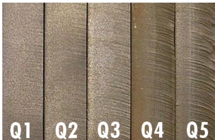
Obr. 3.3 Kvalita povrchu jednotlivých stupňů [24].
