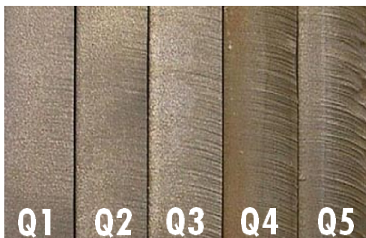
Obr. 3.3 Kvalita povrchu jednotlivých stupňů [24].
