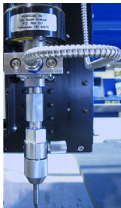
Obr. 1.7 Řezací hlavice pro AWJ [11].
