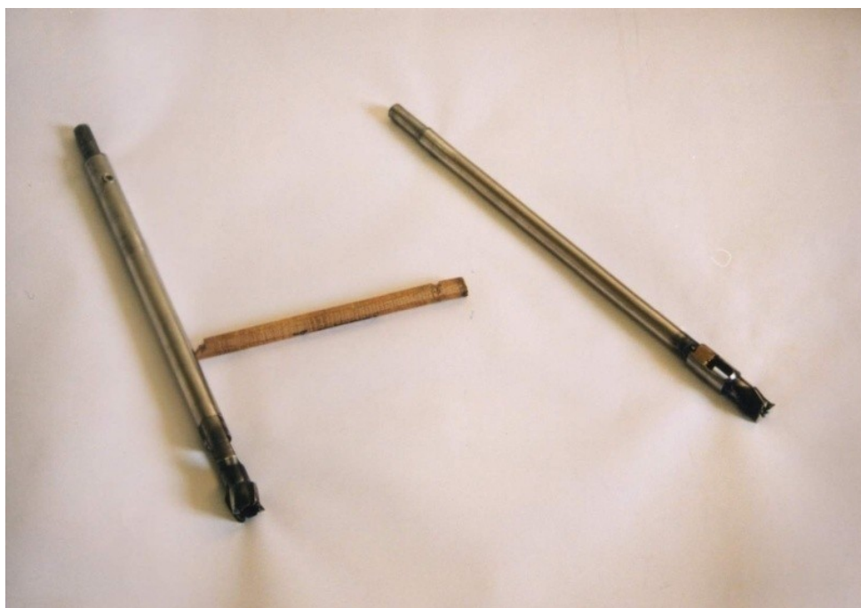
Obr. 2: Vrtáky do elektrické vrtačky (Zdroj: http://www.dendrochronologie.cz/images/foto_galerie/Pokus_vrtaky.jpg )
