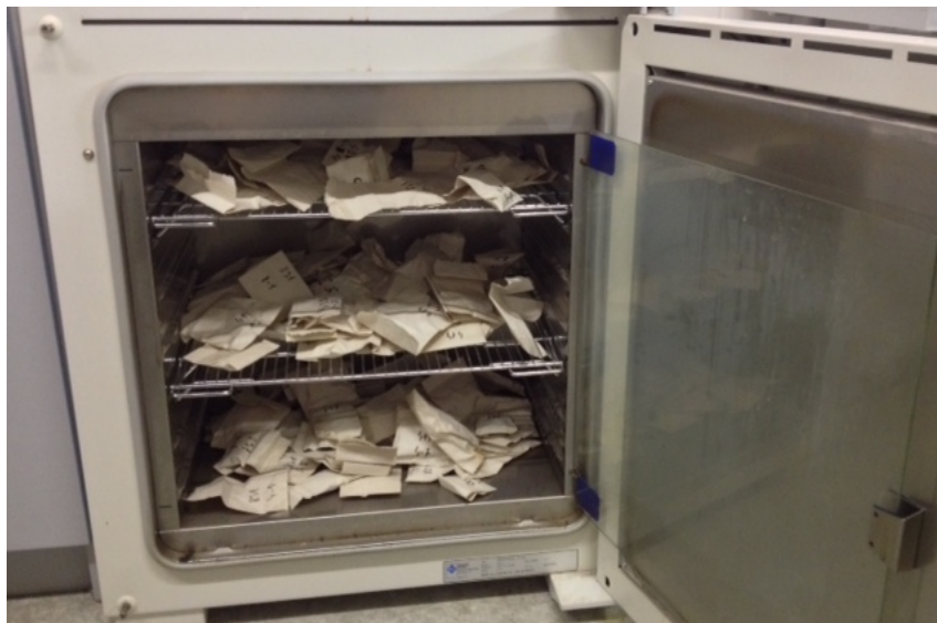
Obr. 13: Jednotlivé sekce v papírových sáčcích v sušičce SANYO
