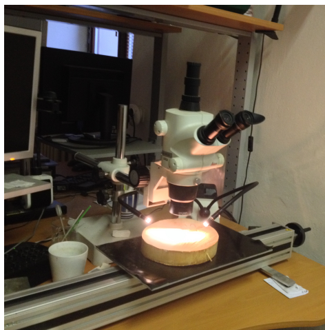
Obr. 6: Speciální měřicí stůl s posuvným šroubovým mechanismem a impulsmetrem
