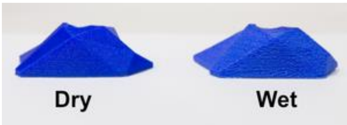
Obrázek 2-2 - Porovnání suchého a navlhělého filamentu při vytisknutí 3D modelu [20]
