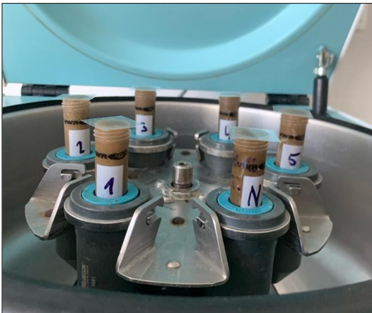
Obrázek 16: centrifuga s připravenými a důkladně označenými zkumavky (Lucie Bezdovová)
