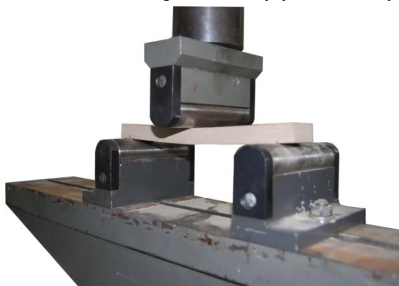
Obr.č. 17: Uspořádání ohybové zkoušky. (Zdroj vlastní; 2014)
