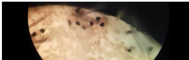
Obr č. 21 - I. typ Panox - tvar průřezu vláken, přiblížení 100x
