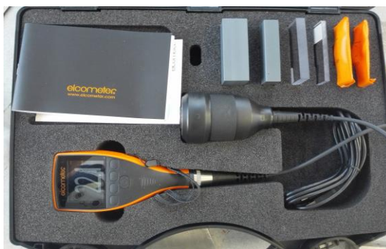
Obr. č. 15 - Tloušťkoměr Elcometer 456
