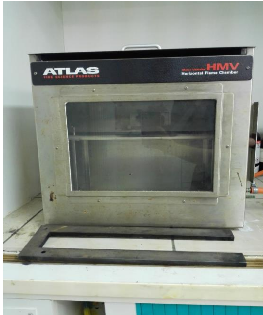
Obr. č. 18 - Spalovací komora
