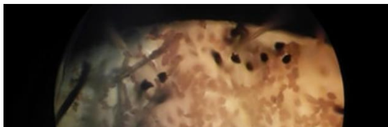
Obr č. 22 - I. typ Panox - tvar průřezu vláken, přiblížení 100x
