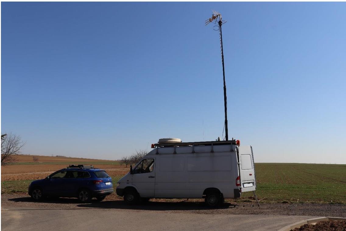
Obr. 28 Specializovaný měřicí vůz ČTÚ s výsuvným anténním stožárem
