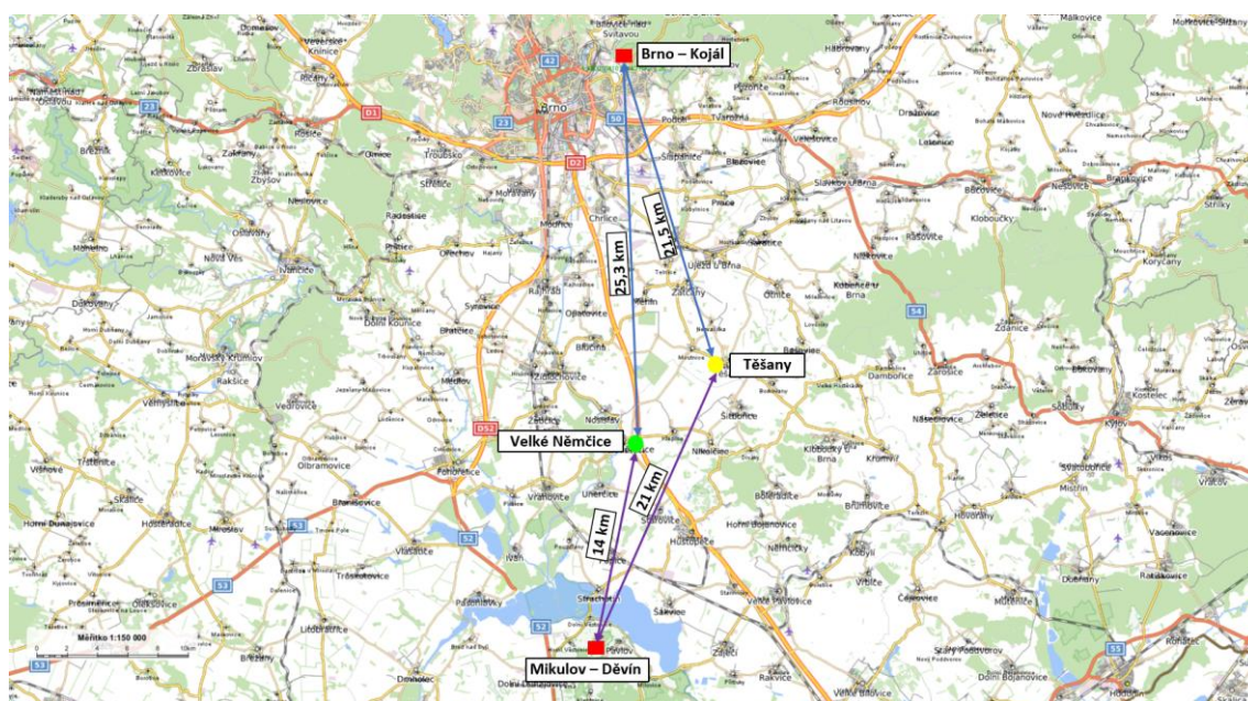
Obr. 41 Pozice vysílačů a měřících bodů a vzdálenosti mezi nimi – druhé terénní měření
