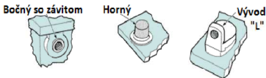
Obr. 2.6: Tvary pólových vývodov akumulátora [5]
