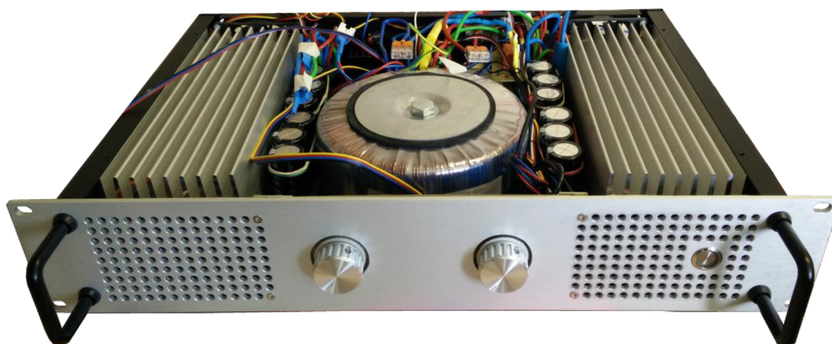
Obr. 8.2 Pohled na přední panel a uspořádání jednotlivých prvků ve škríní
