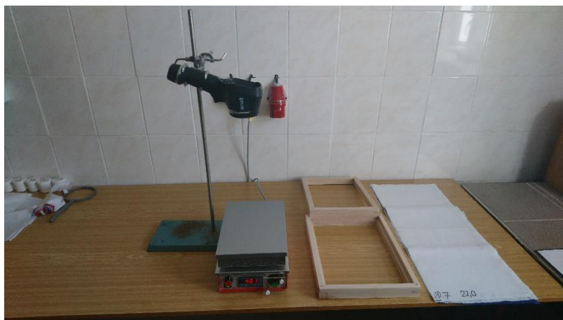
Obrázek 27: Příprava k testování termokamerou a topnou deskou
