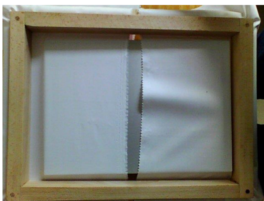
Obrázek 28: Vliv špatně přiloženého vzorku na topnou desku
