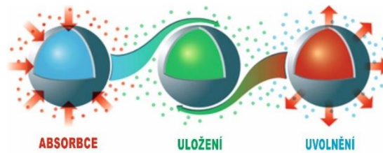
Obrázek 1: Schéma principu PCM (energy.co.kr)
