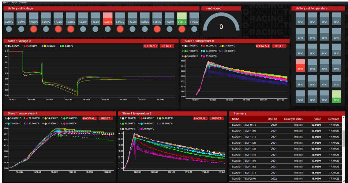
Obr. 2.3: Grafické užívateľské rozhranie Dragon GUI počas testu systému BMS
