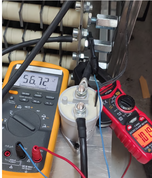
Obr. 2.4: Kontrolné meranie počas testovania segmentu
