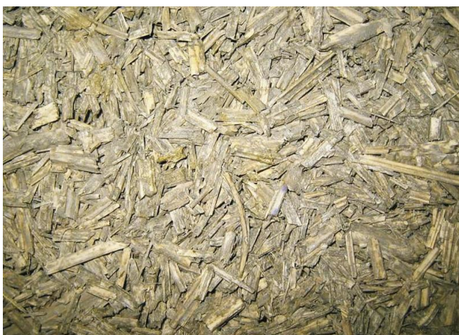
Obr. 4.4 Struktura desky z konopného pazdeří (Zach & Sedlářová, 2008)
