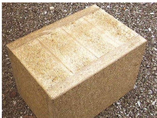
Obr. 4.21 Řez nosným panelem z lisované slámy (Chybík, 2009)
