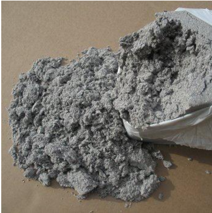
Obr. 4.13 Tepelná izolace na bázi celulózy (www.fixnews.co.cc)
