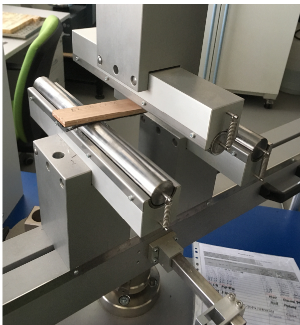
Obr. 20 Průběh ohybové zkoušky na TIRAtest 2850S (Kříž)
