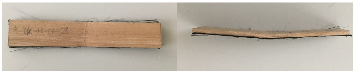
Obr. 21 Zkušební tělesa po zkoušce ohybem (Kříž)
