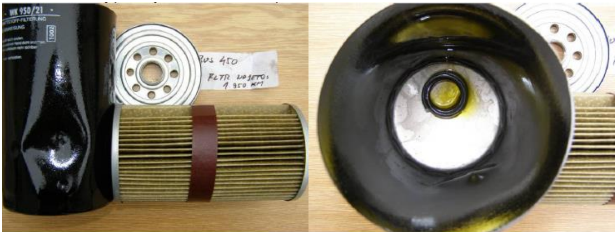
Jemný palivový filtr z vozidla č. 450 po 1950 km
