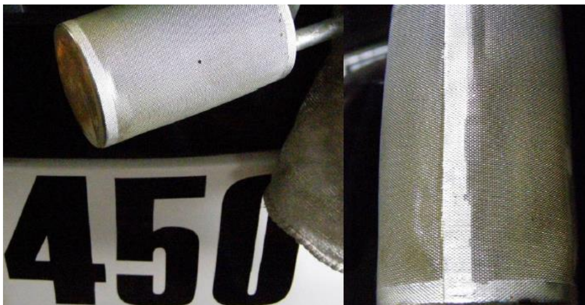
Čistý předfiltr na sání paliva (sací koš) vozidla č. 450 po čtyřech měsících sledovaného provozu
