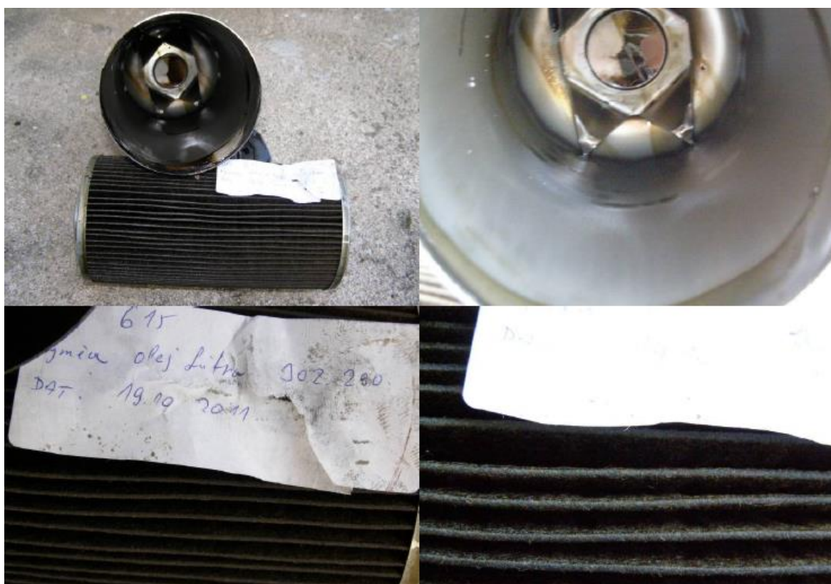
Olejový filtr z vozidla č. 615 po výměně motorového oleje po 42453 km
