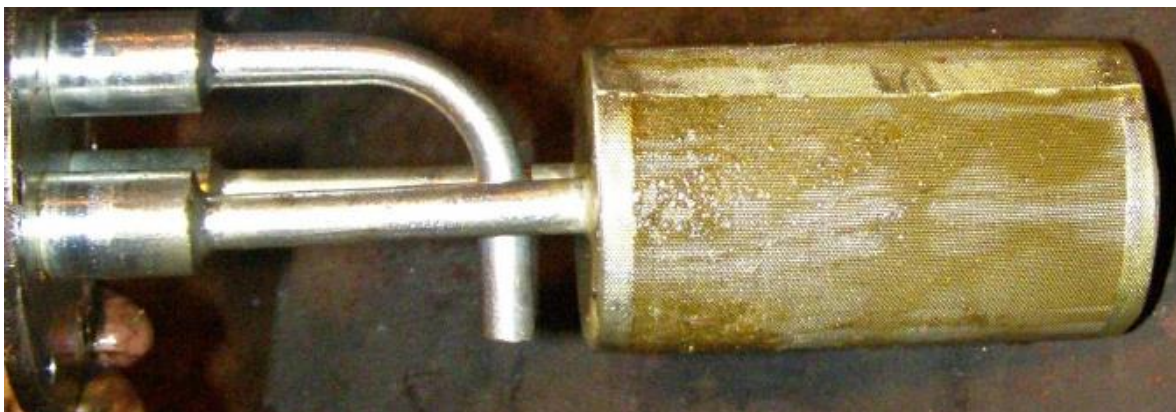
Předfiltr na sání paliva v nádrži autobusu SOR BN 10.5 č. 450
