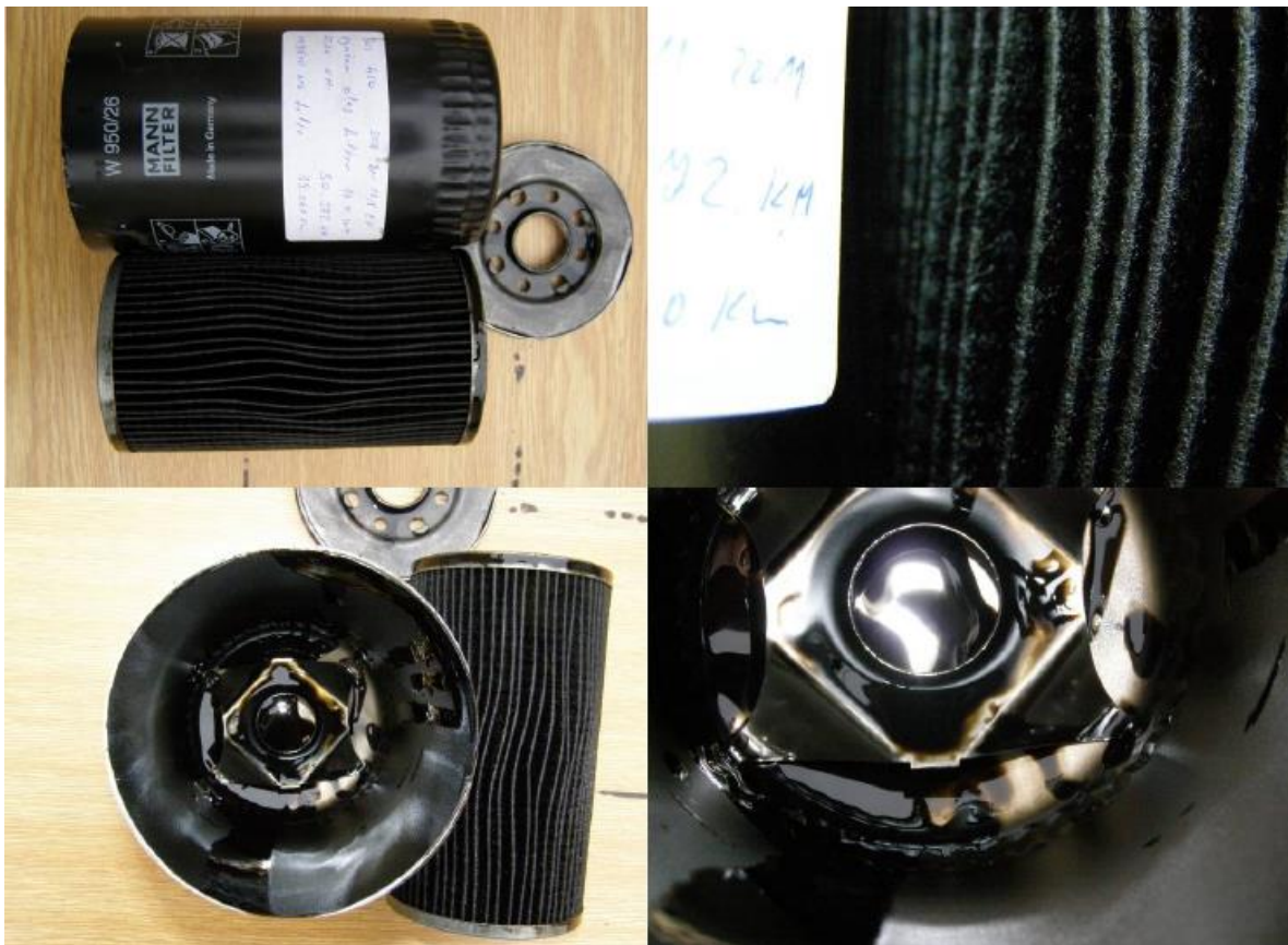
Olejový filtr z vozidla č. 450 po výměně motorového oleje po 39060 km
