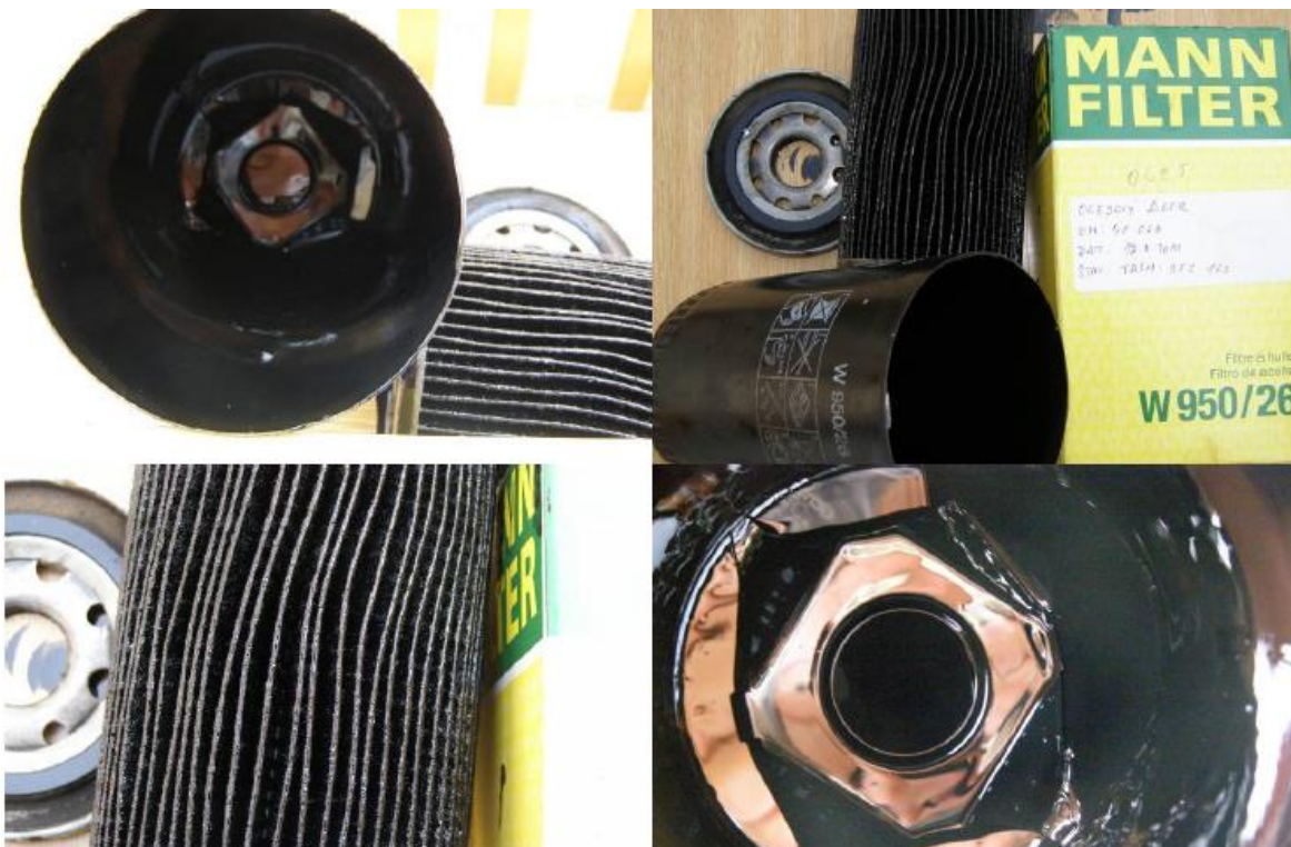
Olejový filtr z vozidla č. 603 po výměně motorového oleje po 41067 km
