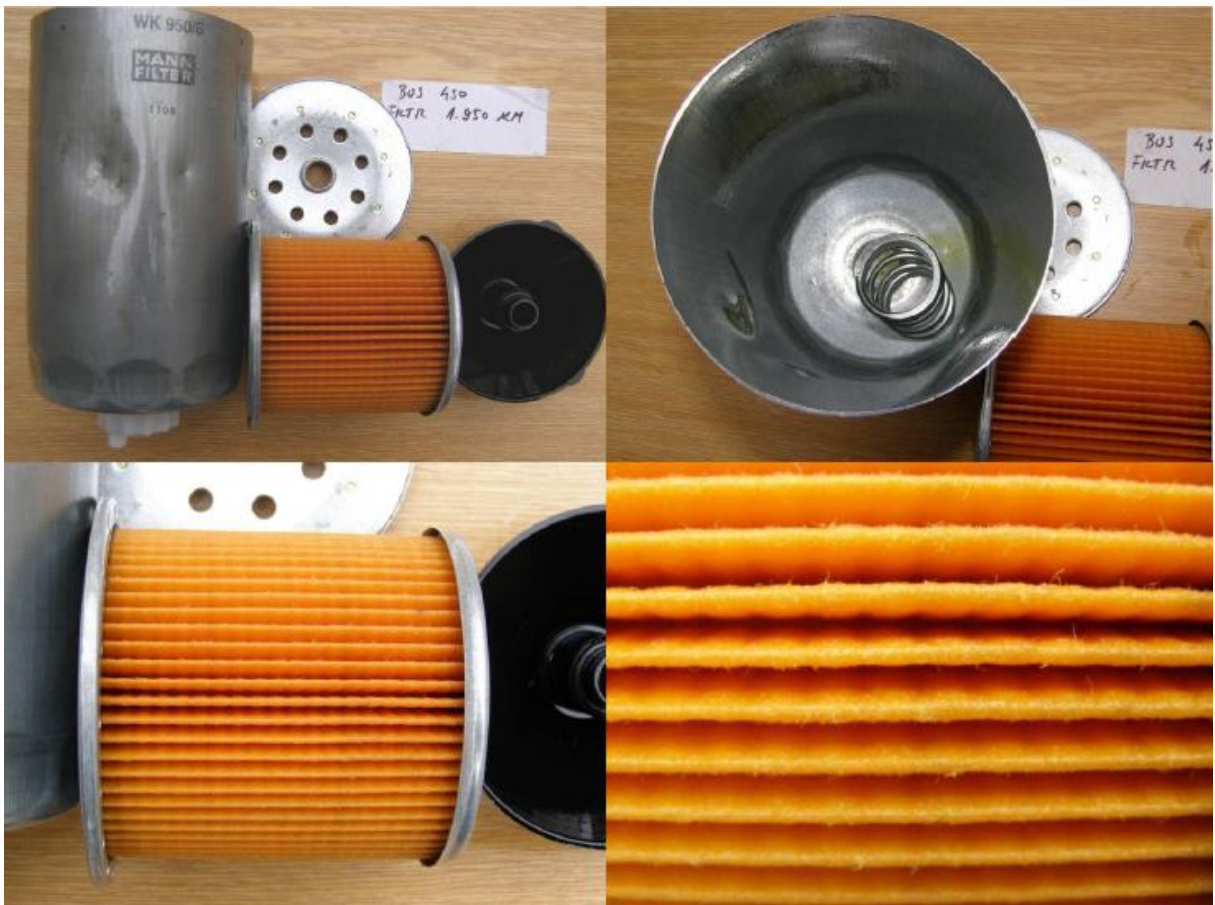
Hrubý palivový filtr z vozidla č. 450 po 1950 km
