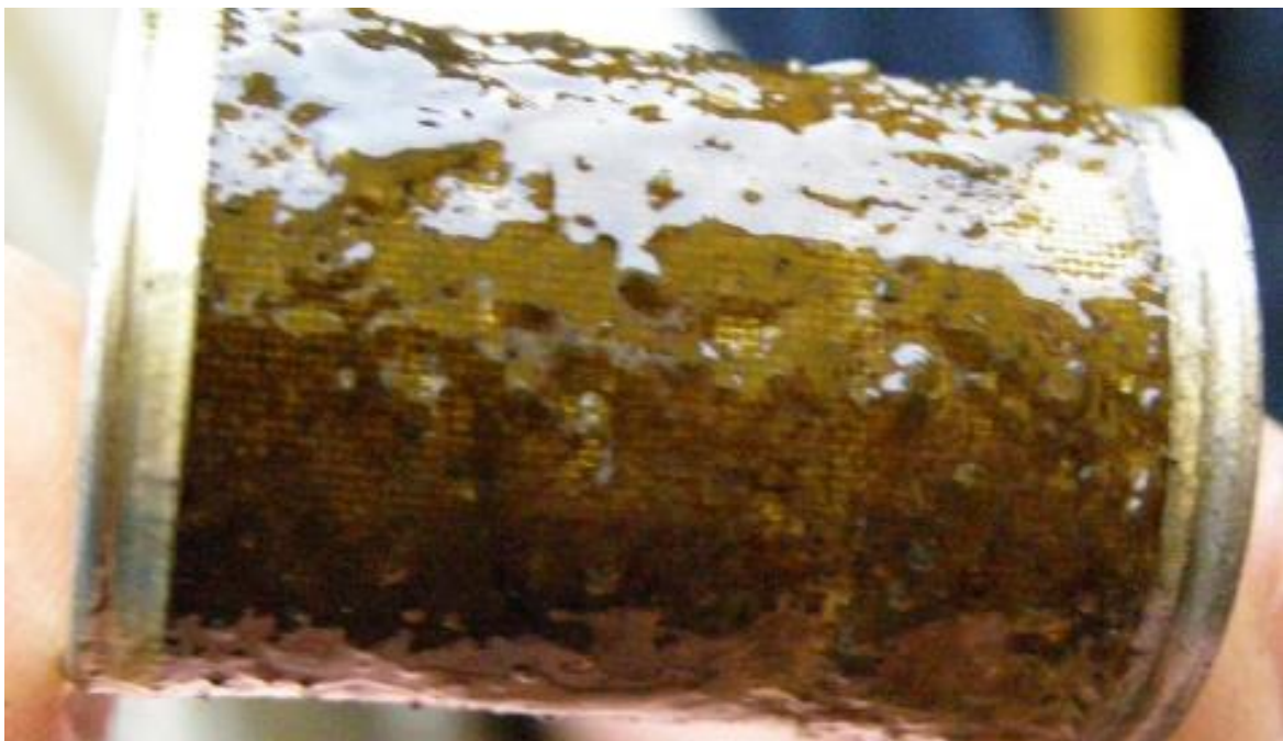
Sítka z odlučovače vody palivového systému autobusu SOR BN 10.5 č. 450 s úsadami
