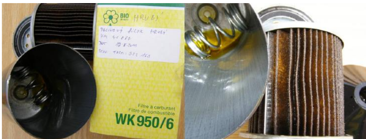
Hrubý palivový filtr z vozidla č. 603 po 41067 km
