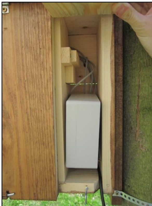
Obrázek 10: Způsob umístění řídicí jednotky (počítač) v prostoru zadní části budky
