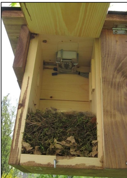
Obrázek 11: Způsob umístění a uchycení kamery, teplotního čidla a mikrofonu v prostoru budky
