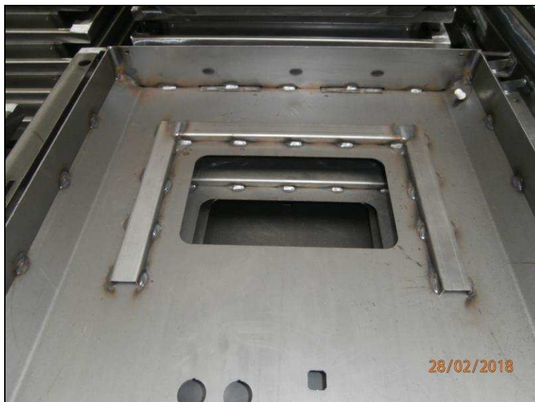
Obr. 37 Ukázka svarů u dveří rozváděče.
