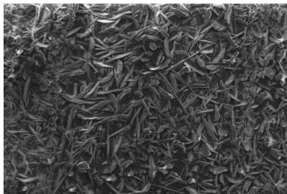
Obr. 35 Příklad fosfátované vrstvy [37]
