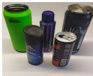
Obr. 14 Příklad vyrobené součásti ze zpětného protlačování
