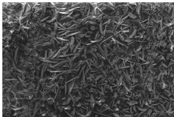
Obr. 35 Příklad fosfátované vrstvy [37]
