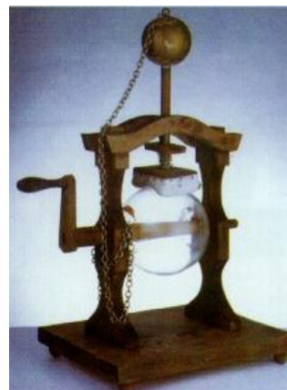
Obr. 92 – Replika Divišovy třecí elektriky, kterou nazýval elektrum [77]
