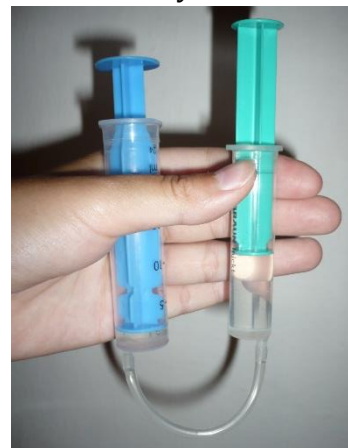
Obr. 67 – Hydraulické zařízení z injekčních stříkaček [foto: autorka]
