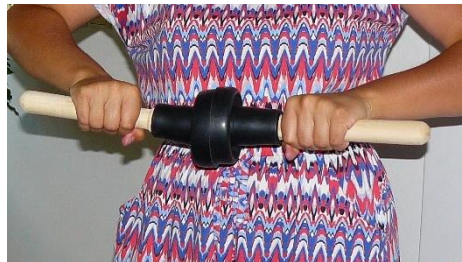
Obr. 74 – Magdeburské polokoule ze zvonů na odpad [foto: autorka]
