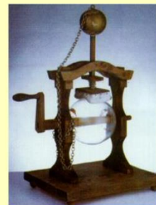
Obr. 4: Replika Divišovy třecí elektriky, nazývané elektrum [77]
