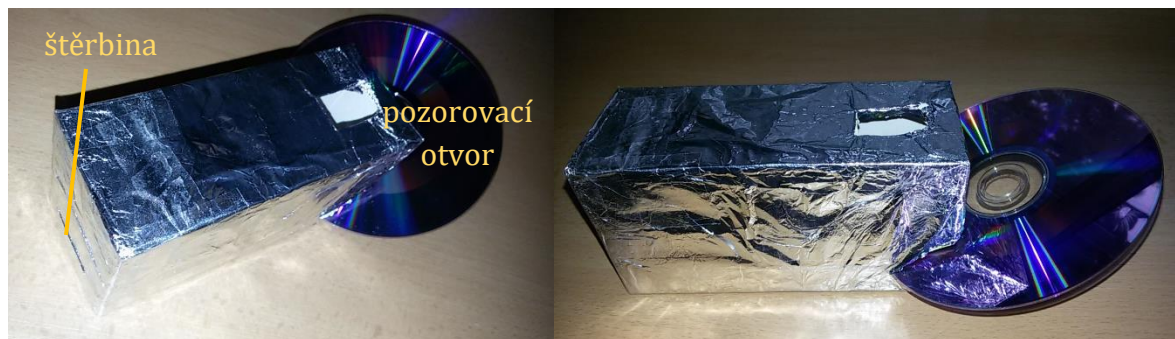
Obr. 86 – Spektroskop z CD a krabičky od čaje [foto: autorka]
