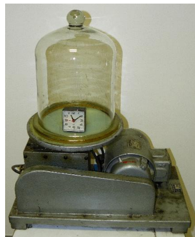
Obr. 2 – Heuristický pokus: ve vakuu se zvuk nešíří [foto: autorka]
