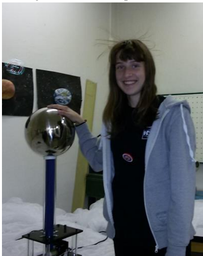
Obr. 1 – Kvalitativní pokus: odpuzování souhlasných elektrických nábojů [foto: autorka]
