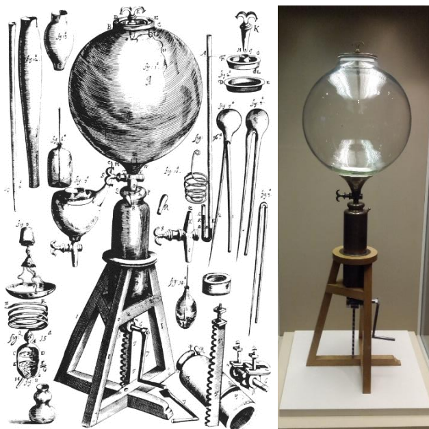
Obr. 70 – Boylova vývěva: náčrtek, vpravo její replika z londýnského muzea [38], [66]
