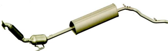
Obr. 24 Verze výfukového systému pro zemní plyn
