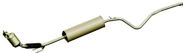
Obr. 23 Verze výfukového systému pro benzin
