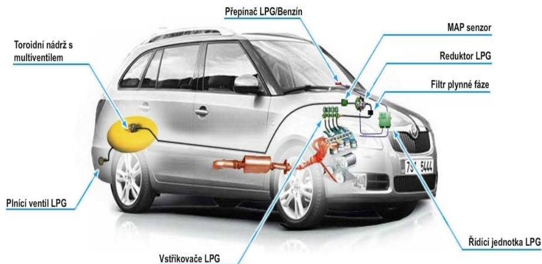
Obr. 4 Přestavba Fabie druhé generace na LPG
