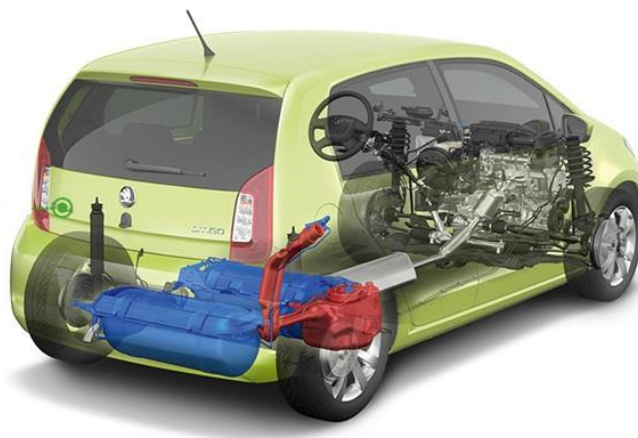
Obr. 21 Zástavbové řešení palivových nádrží u modelu Citigo G-TEC
