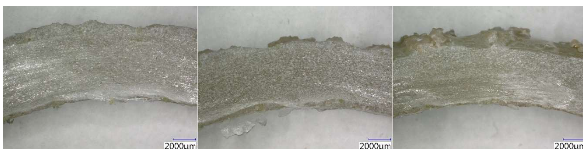
Obrázek 49 Vzorky po vystavení agresivnímu prostředí po 90 dnech při zvětšení 20x – podélný řez v ohýbané části (zleva H 2 O při 20 °C, alkalické prostředí při 20 °C, alkalické prostředí při 40 °C) [Aneta Blahová]
