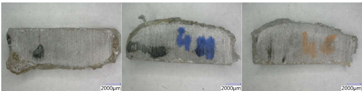
Obrázek 52 Vzorky po vystavení agresivnímu prostředí po 180 dnech při zvětšení 20x – přímý řez v ohýbané části (zleva H 2 O při 20 °C, alkalické prostředí při 20 °C, alkalické prostředí při 40 °C) [Aneta Blahová]
