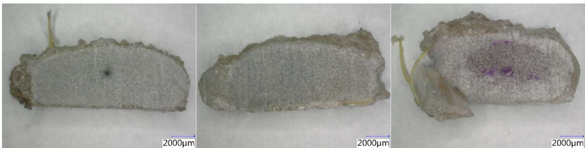
Obrázek 56 Vzorky po vystavení agresivnímu prostředí po 360 dnech při zvětšení 20x – přímý řez v ohýbané části (zleva H 2 O při 20 °C, alkalické prostředí při 20 °C, alkalické prostředí při 40 °C) [Aneta Blahová]
