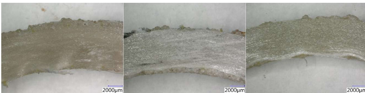
Obrázek 53 Vzorky po vystavení agresivnímu prostředí po 180 dnech při zvětšení 20x – podélný řez v ohýbané části (zleva H 2 O při 20 °C, alkalické prostředí při 20 °C, alkalické prostředí při 40 °C) [Aneta Blahová]
