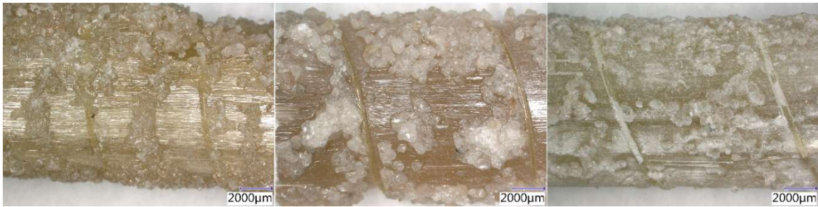
Obrázek 50 Vzorky po vystavení agresivnímu prostředí po 90 dnech při zvětšení 20x – povrch v přímé části (zleva H 2 O při 20 °C, alkalické prostředí při 20 °C, alkalické prostředí při 40 °C) [Aneta Blahová]
