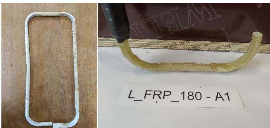
Obrázek 39 Vlevo – třmínek v dodaném stavu, vpravo – třmínek po řezání připravený k osazení do formy [Aneta Blahová]
