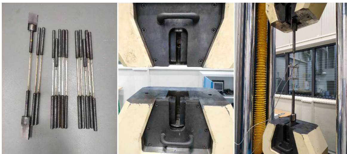
Obrázek 34 Příprava na zkoušení přímých výztuží v tahu (zleva-vzorky osazené závitovými tyčemi a kotvami, čelisti lisu, připravený vzorek ke zkoušení) [Aneta Blahová]
