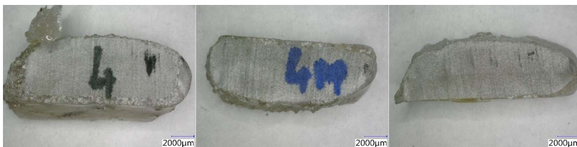
Obrázek 48 Vzorky po vystavení agresivnímu prostředí po 90 dnech při zvětšení 20x – přímý řez v ohýbané části (zleva H 2 O při 20 °C, alkalické prostředí při 20 °C, alkalické prostředí při 40 °C) [Aneta Blahová]
