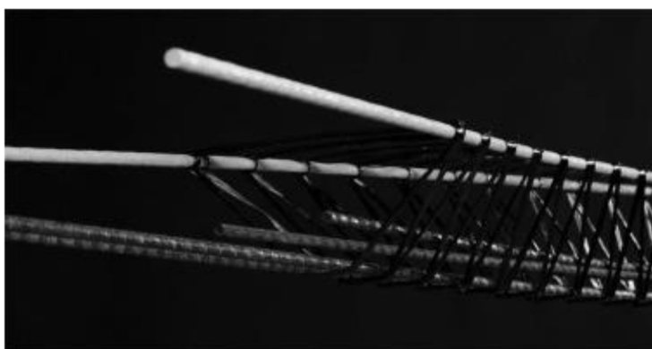
Obrázek 14 Výroba armokoše vinutím okolo trnů [11]
