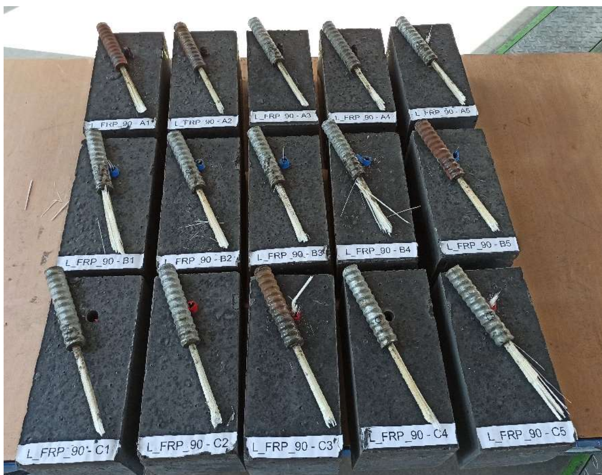
Obrázek 42 Vzorky vystavené agresivnímu prostředí po dobu 90 dní po pevnostní zkoušce (shora-H 2 O při 20 °C, alkalické prostředí při 20 °C, alkalické prostředí při 40 °C) [Aneta Blahová]
