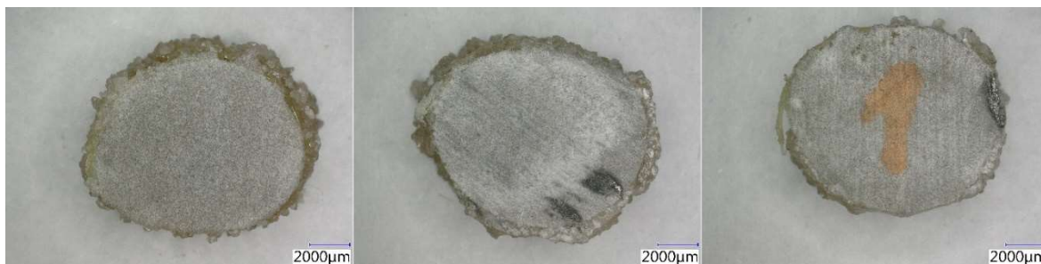
Obrázek 47 Vzorky po vystavení agresivnímu prostředí po 90 dnech při zvětšení 20x – řez v přímé části (zleva H 2 O při 20 °C, alkalické prostředí při 20 °C, alkalické prostředí při 40 °C) [Aneta Blahová]
