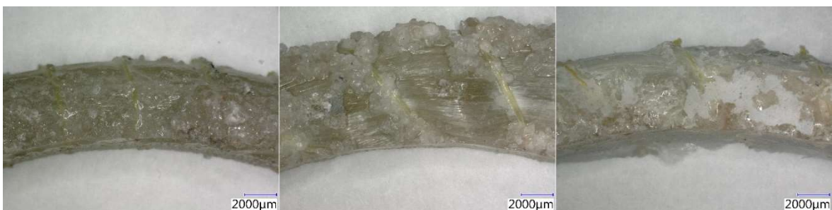
Obrázek 58 Vzorky po vystavení agresivnímu prostředí po 360 dnech při zvětšení 20x – povrch v přímé části (zleva H 2 O při 20 °C, alkalické prostředí při 20 °C, alkalické prostředí při 40 °C) [Aneta Blahová]
