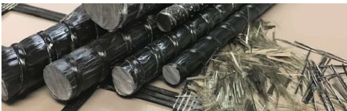
Obrázek 4 BFRP výztuž s ukázkou vláken [21]
