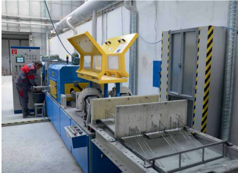
Obrázek 7 Začátek pultruzní linky pro výrobu FRP tyčí [7]
