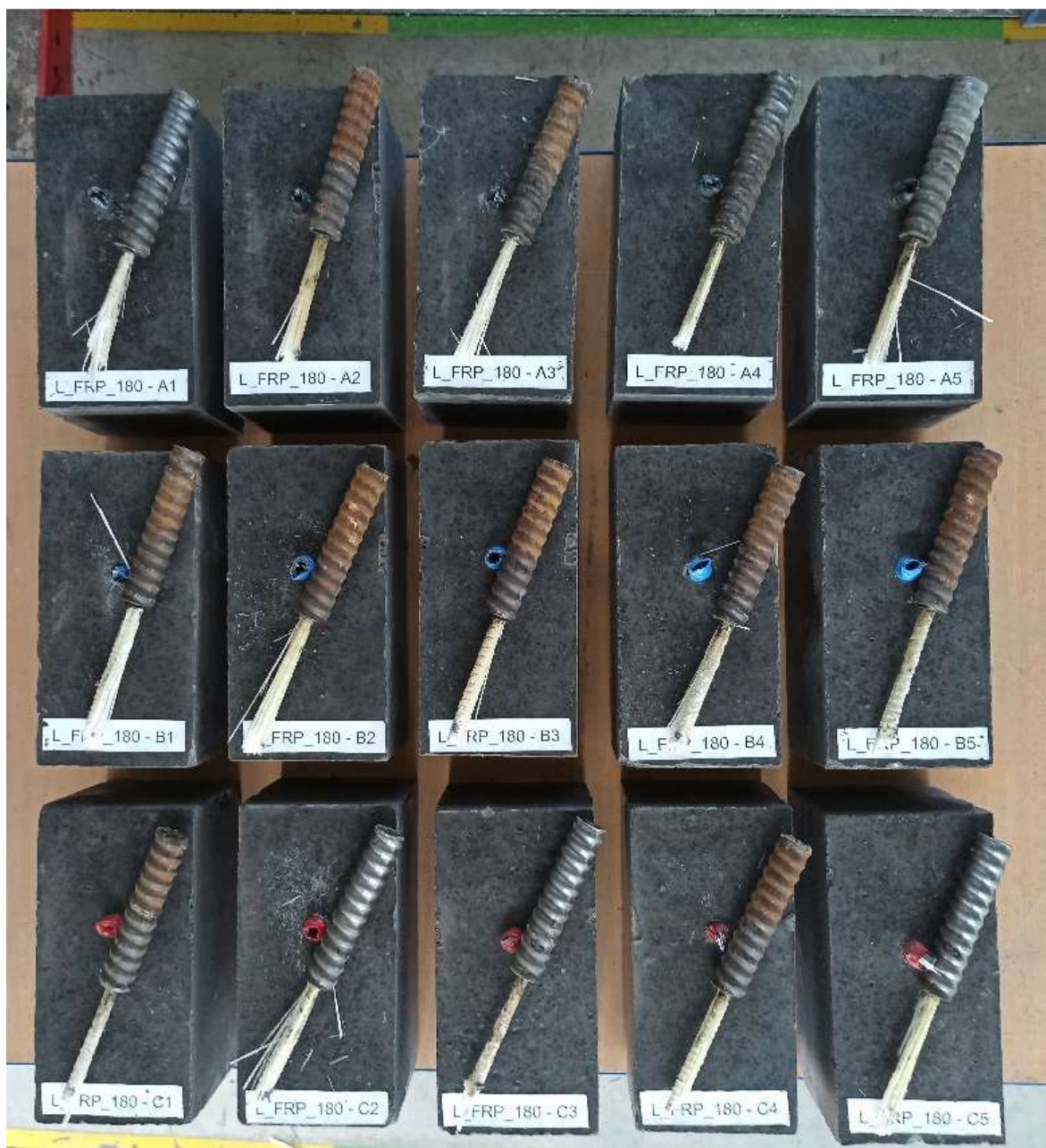
Obrázek 43 Vzorky vystavené agresivnímu prostředí po dobu 180 dní po pevnostní zkoušce (shora-H2O při 20 °C, alkalické prostředí při 20 °C, alkalické prostředí při 40 °C) [Aneta Blahová]
