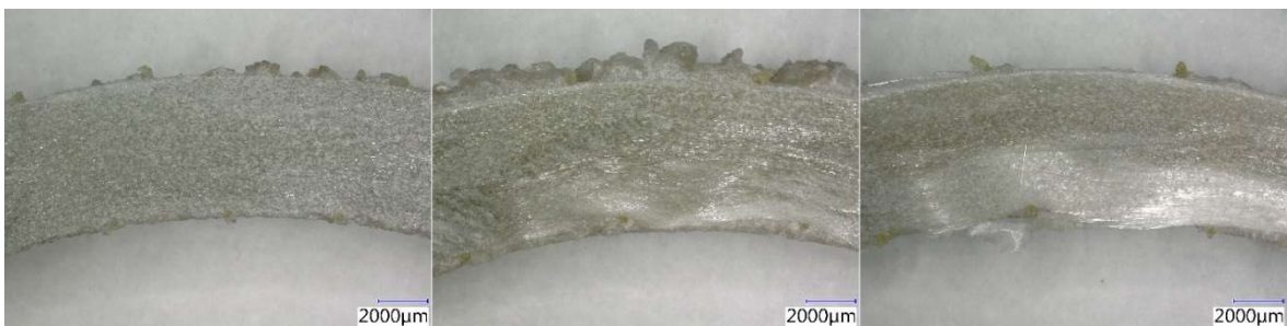
Obrázek 57 Vzorky po vystavení agresivnímu prostředí po 360 dnech při zvětšení 20x – podélný řez v ohýbané části (zleva H 2 O při 20 °C, alkalické prostředí při 20 °C, alkalické prostředí při 40 °C) [Aneta Blahová]
