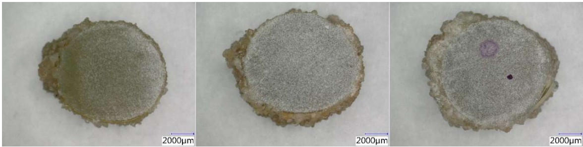
Obrázek 55 Vzorky po vystavení agresivnímu prostředí po 360 dnech při zvětšení 20x – řez v přímé části (zleva H 2 O při 20 °C, alkalické prostředí při 20 °C, alkalické prostředí při 40 °C) [Aneta Blahová]
