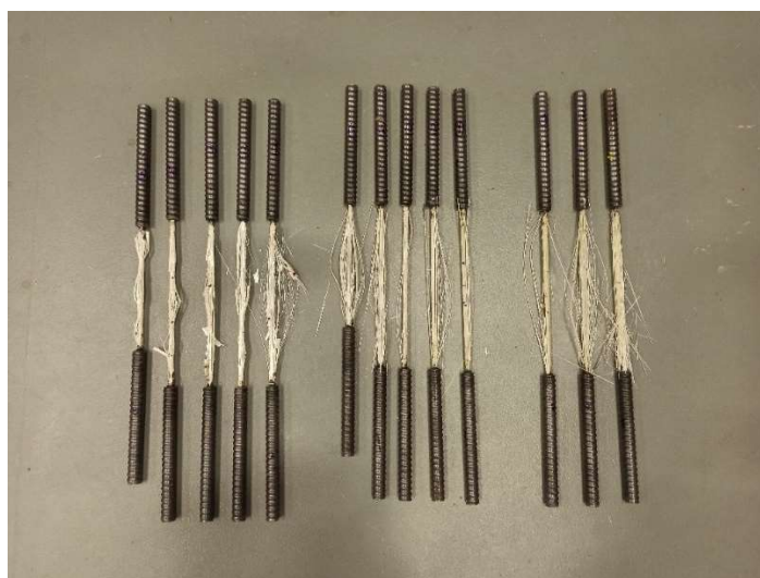
Obrázek 38 Pevnost v tahu přímých prutů po 360 dnech expozice (zleva-vodní prostředí, alkalické prostředí při 20 °C, alkalické prostředí při 40 °C) [Aneta Blahová]
