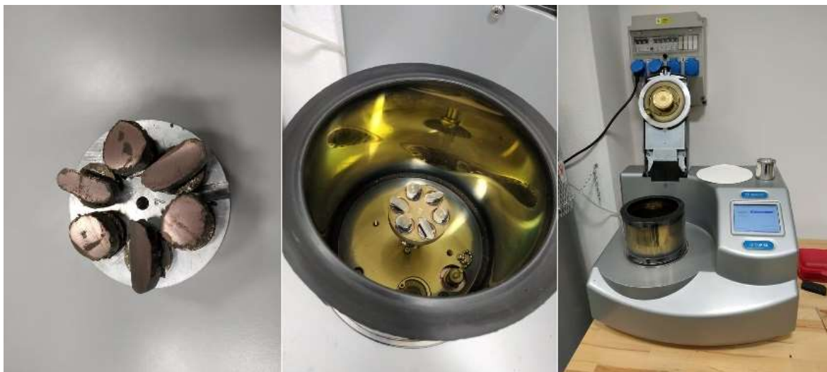
Obrázek 62 Příprava vzorů ve vakuovací komoře [Aneta Blahová]
