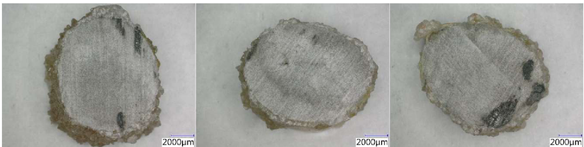
Obrázek 51 Vzorky po vystavení agresivnímu prostředí po 180 dnech při zvětšení 20x – řez v přímé části (zleva H 2 O při 20 °C, alkalické prostředí při 20 °C, alkalické prostředí při 40 °C) [Aneta Blahová]
