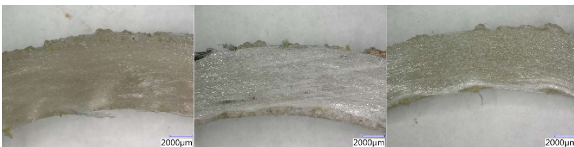
Obrázek 53 Vzorčky po vystavení agresivnímu prostředí po 180 dnech při zvětšení 20x – podélný řez v ohýbané části (zleva H 2 O při 20 °C, alkalické prostředí při 20 °C, alkalické prostředí při 40 °C) [Aneta Blahová]
