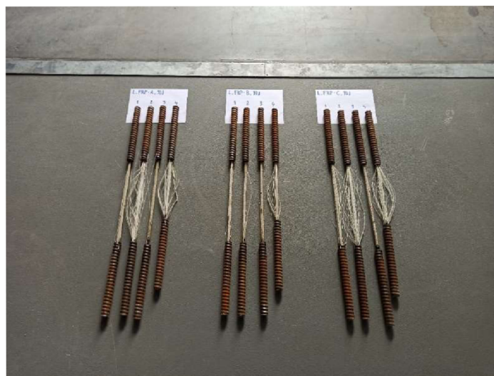
Obrázek 36 Pevnost v tahu přímých prutů po 90 dnech expozice (zleva-vodní prostředí, alkalické prostředí při 20 °C, alkalické prostředí při 40 °C) [Aneta Blahová]
