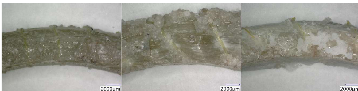
Obrázek 58 Vzorky po vystavení agresivnímu prostředí po 360 dnech při zvětšení 20x – povrch v přímé části (zleva H 2 O při 20 °C, alkalické prostředí při 20 °C, alkalické prostředí při 40 °C) [Aneta Blahová]
