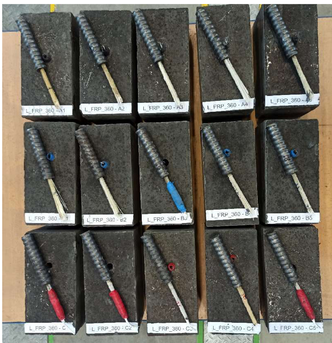
Obrázek 44 Vzorky vystavené agresivnímu prostředí po dobu 360 dní po pevnostní zkoušce (shora-H 2 O při 20 °C, alkalické prostředí při 20 °C, alkalické prostředí při 40 °C) [Aneta Blahová]
