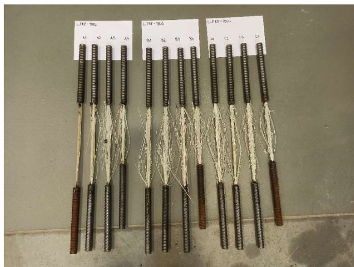
Obrázek 37 Pevnost v tahu přímých prutů po 180 dnech expozice (zleva-vodní prostředí, alkalické prostředí při 20 °C, alkalické prostředí při 40 °C) [Aneta Blahová]
