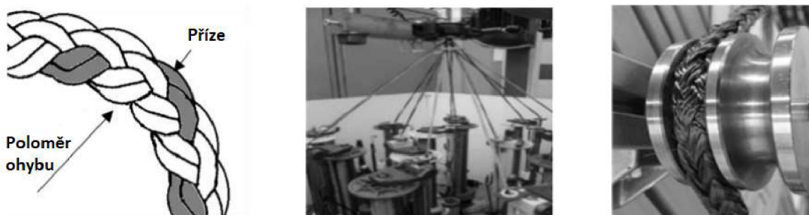
Obrázek 13 vlevo-schéma rotace přízí, uprostřed-motor na splétání přízí, vpravo-formování ohýbaných částí [10]
