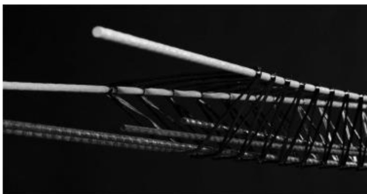
Obrázek 14 Výroba armokoše vinutím okolo trnů [11]
