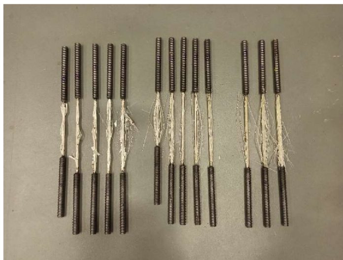
Obrázek 38 Pevnost v tahu přímých prutů po 360 dnech expozice (zleva-vodní prostředí, alkalické prostředí při 20 °C, alkalické prostředí při 40 °C) [Aneta Blahová]
