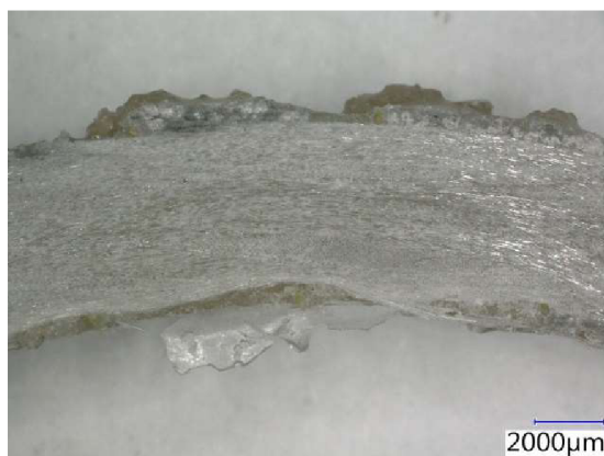
Obrázek 59 Vzorek po vystavení agresivnímu prostředí po 90 dnech při zvětšení 20x – řez v ohýbané části (uložený v alkalickém prostředí při 20 °C) [Aneta Blahová]
