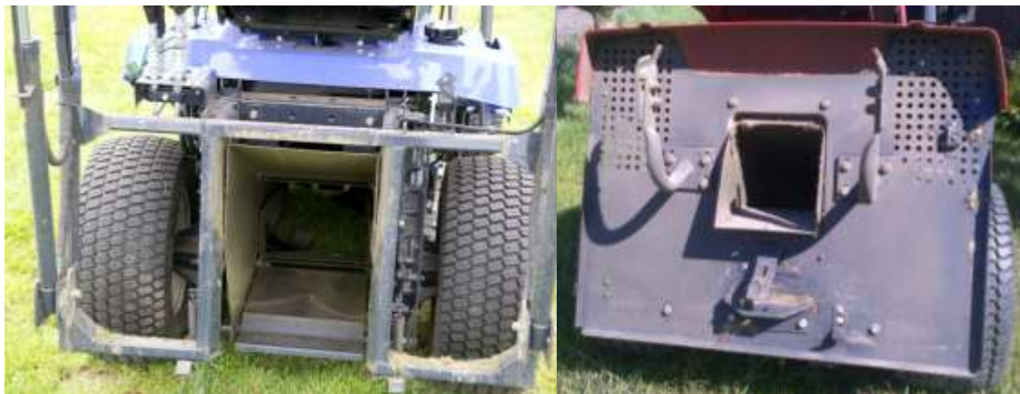
Obr.6 a Obr.7: Porovnanie veľkosti a umiestnenia vyhladzovacieho otvoru ISEKI SXG 323HL a STARJET AJ102-22H (foto autor).
