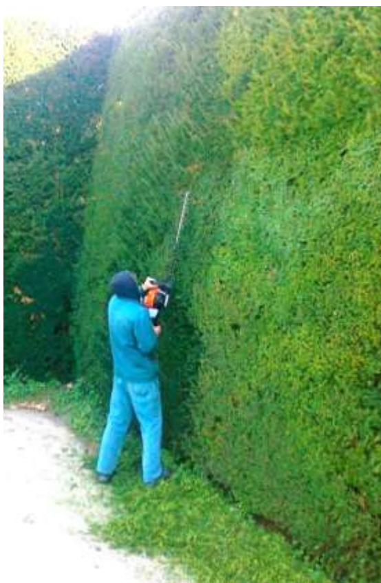
Obr.13: použitie predĺženej varianty lišty plotostrihu s dĺžkou 1,0 m (foto autor).
