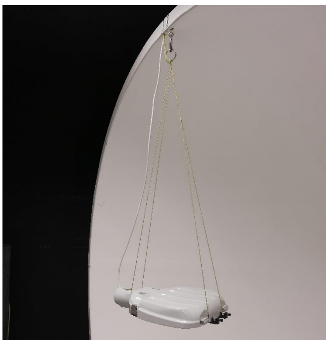
Obr. 6.10 Uchycení svítidla v kulovém integrátoru
