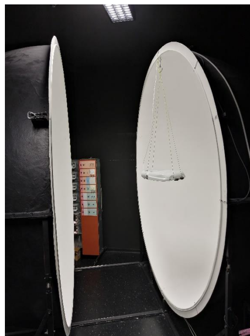
Obr. 6.11 Sestava měření v kulovém integrátoru
