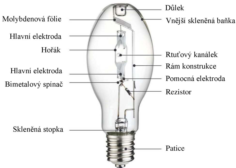
Obr. 4.1 Konstrukce halogenidové výbojky [40]
