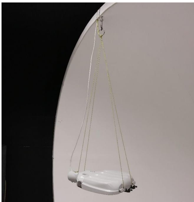
Obr. 6.10 Uchycení svítidla v kulovém integrátoru
