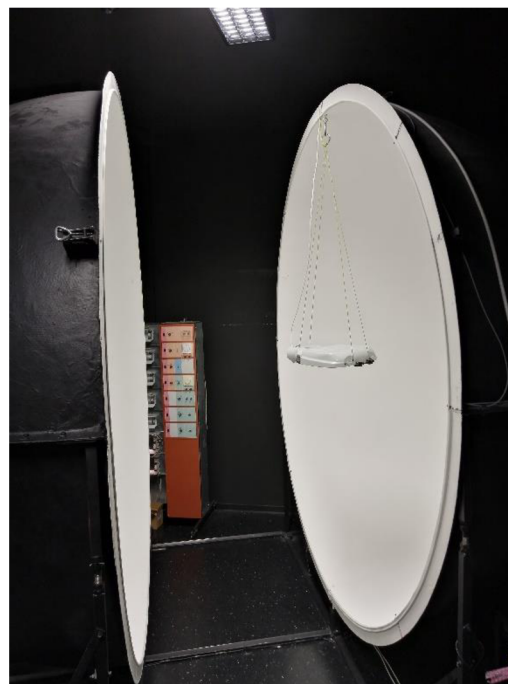
Obr. 6.11 Sestava měření v kulovém integrátoru
