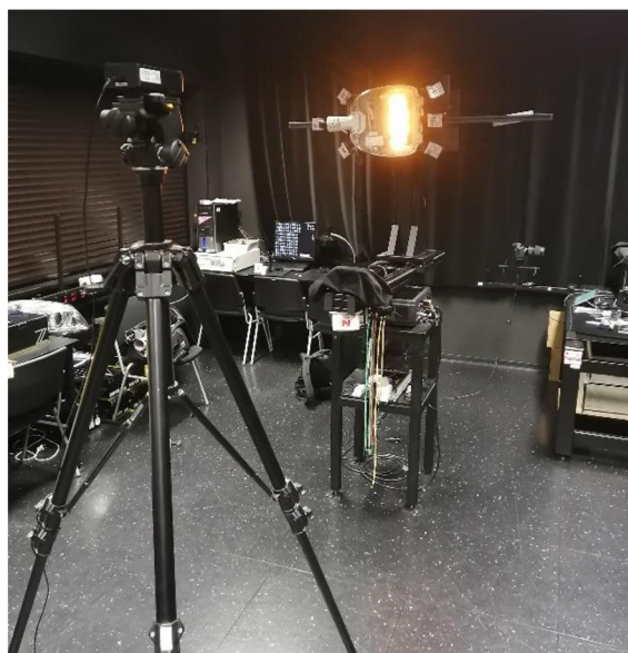
Obr. 6.13 Simulace měření křivek svítivosti
