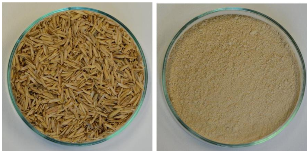
Obr. 15: Slupky, organicko-anorganické plnivo v surovém stavu a jako namleté plnivo. [21]
