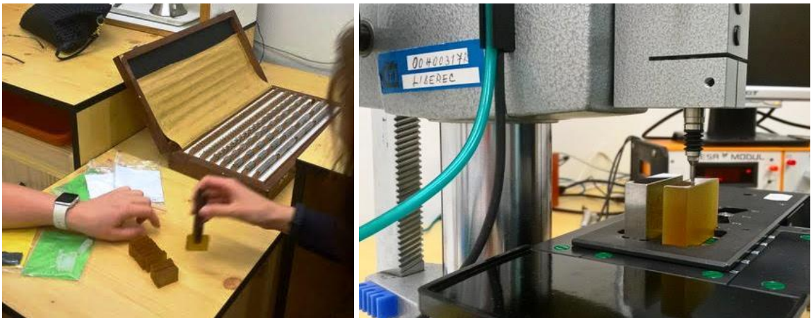
Obr. 20: Sada ocelových etalonových měřidel a umístění kompozitního měřidla do měřicího přístroje. Kalibrace měřidla. Zdroj – vlastní fotografie.
