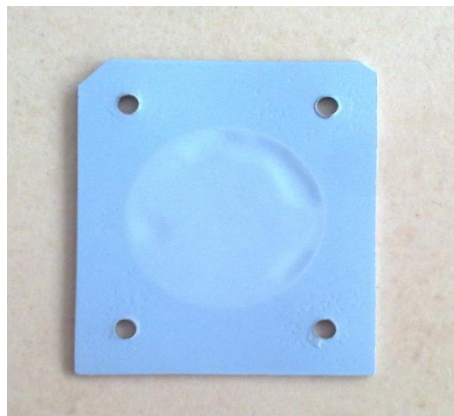
Obr. 4.3: Senzor po laminačním procesu s využitím progresivní laminace a deformovanou membránou
