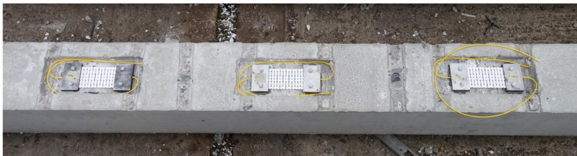
Obr. 4.57: Celkový pohled na připevněnou sadu optovláknových senzorů vytvořených na LTCC substrátu
