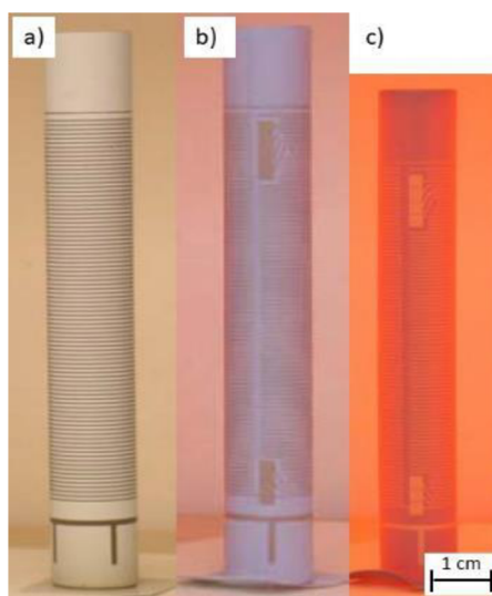
Obr. 1.13: Výpal LTCC struktury a) vyhoření organických složek b) přechod na teplotu výpalu c) teplota výpalu struktury [34]
