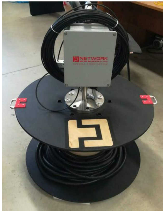
Obr. 4.72: Kompletní senzor pro měření v teploty zásobnicích
