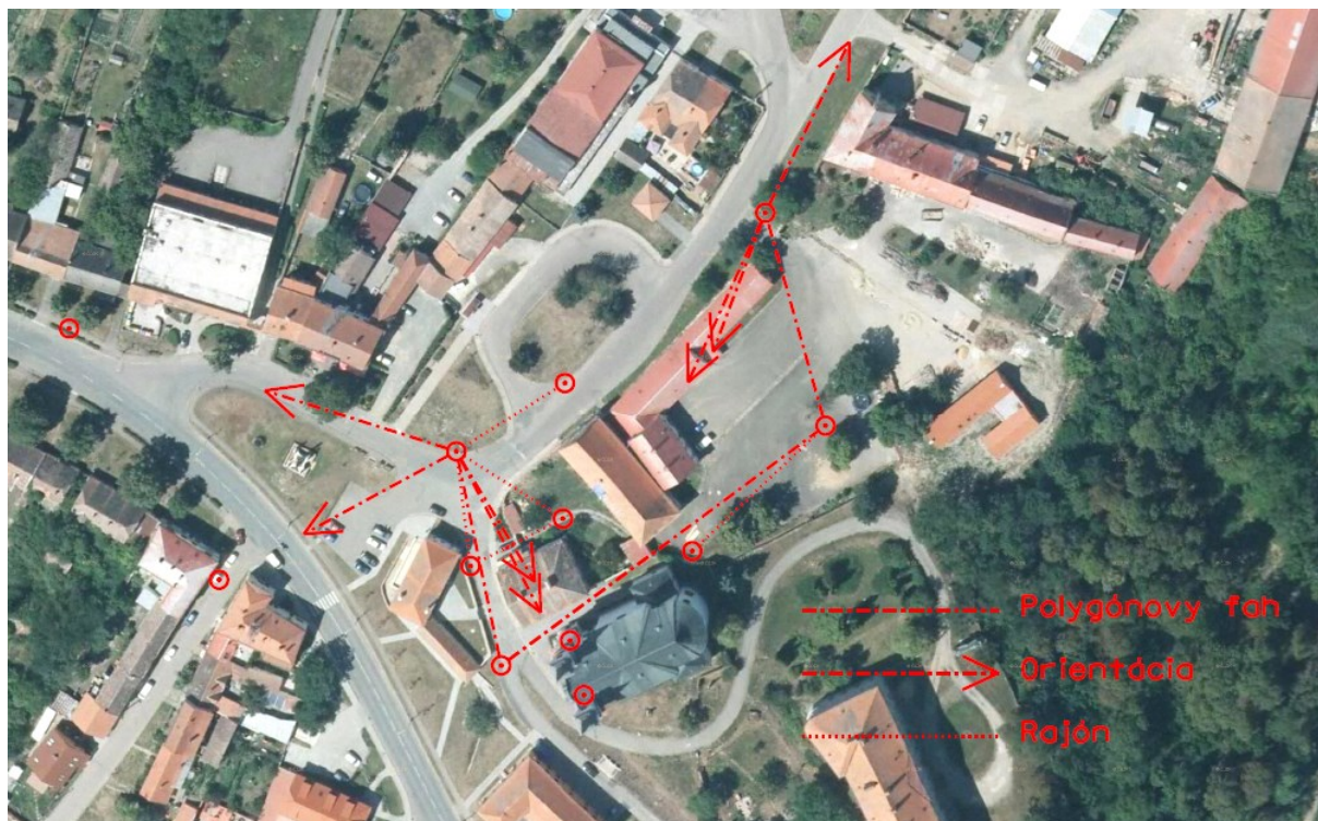
Obr. 3.5 Kombinácia metód GNSS polygónového ťahu a rajónov
