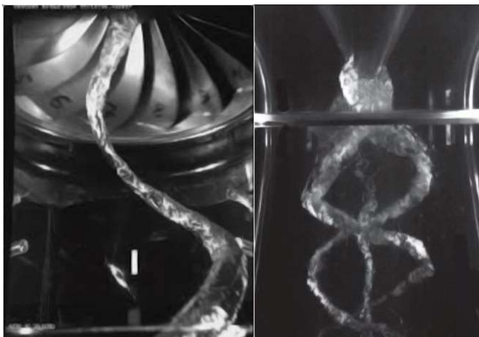
Obr. 4.2 Vírový cop při podoptimálním provozu (vlevo) [11], Zdvojený vírový cop (vpravo) [12]
