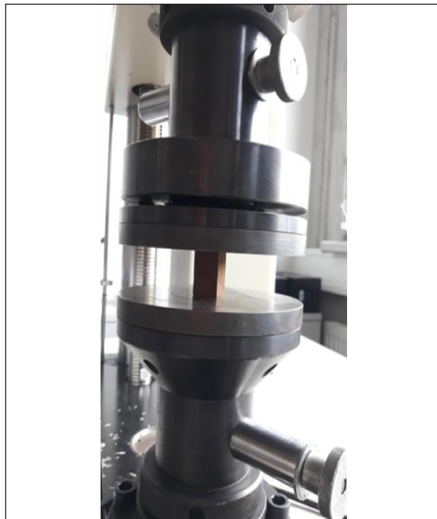
Obrázek 16: Čelisti pro měření pevnosti v tlaku podél vláken (autor)
