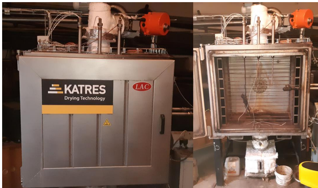
Obrázek 15: Komora KATRES na termickou úpravu (autor)
