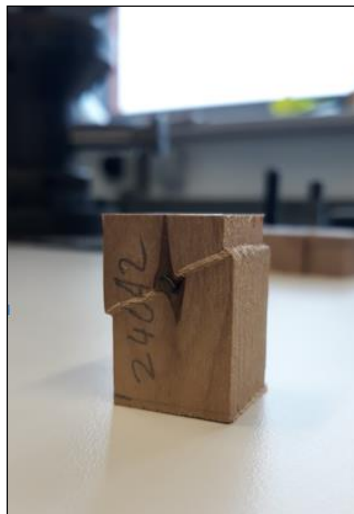
Obrázek 17: Ukázka vzorku po zkoušce pevnosti v tlaku podél vláken (autor)
