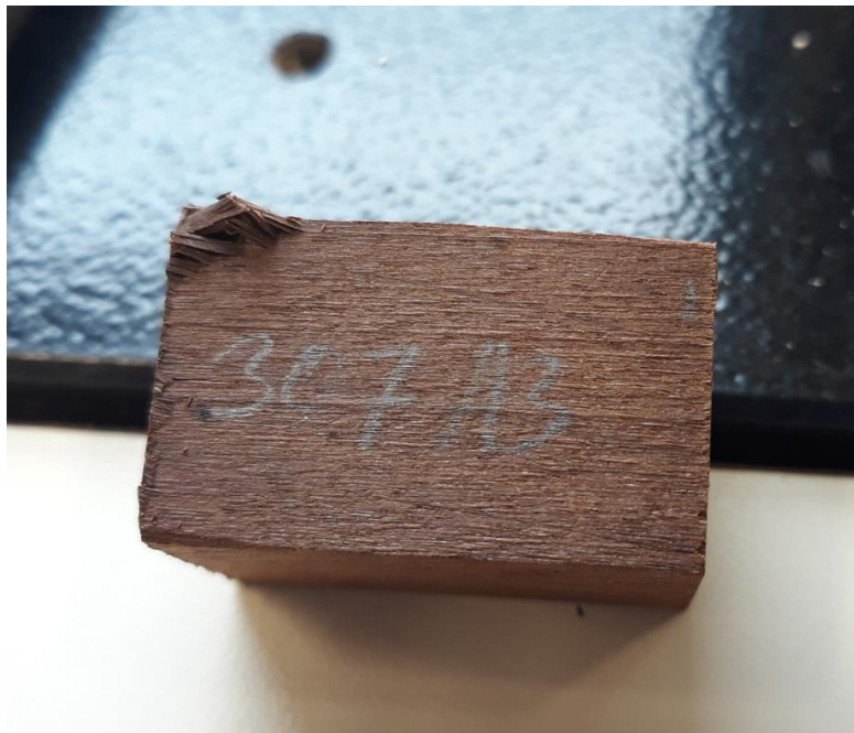
Obrázek 14: Termicky upravený vzorek pro zkoušku pevnosti v tlaku podél vláken (autor)
