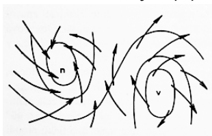
Obr. 1 Schéma proudění vzduchu mezi tlakovou výší (V) a tlakovou níží (N)
