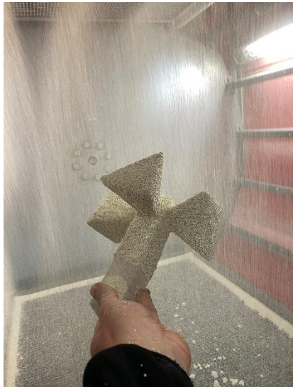
Obr. 5 Sprchový posyp modelu žáruvzdorným materiálem.
