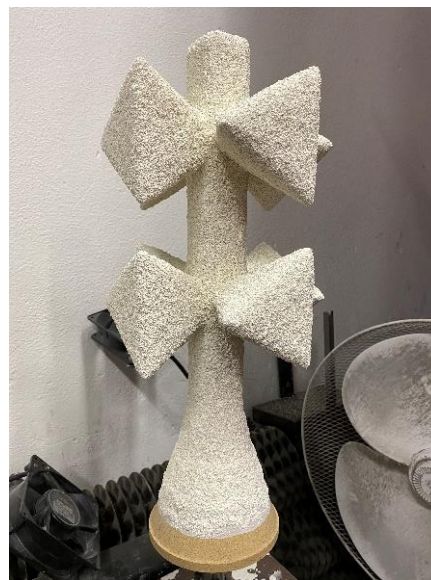
Obr. 7 Sušení zesilovacího obalu.
