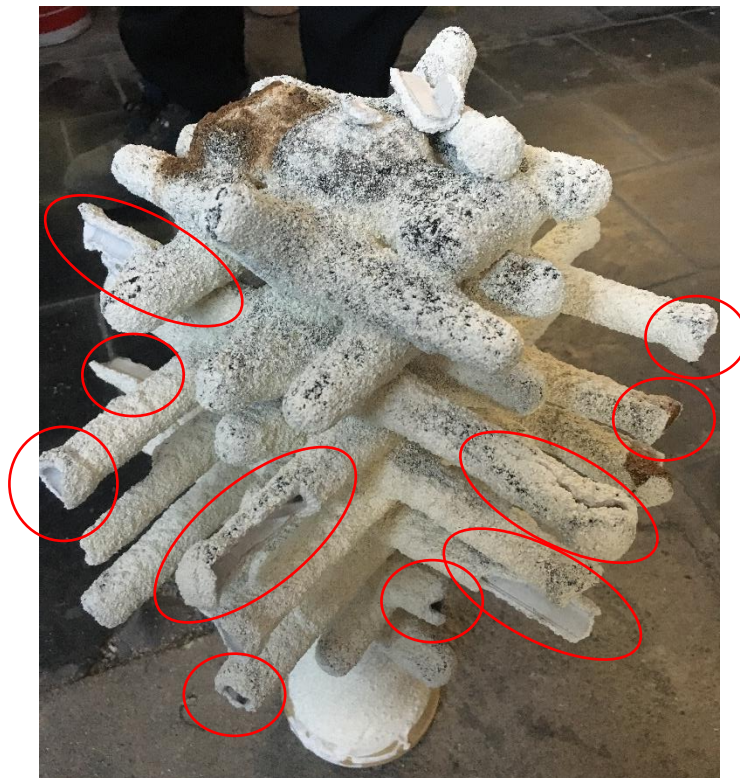
Obr. 61 Keramická skořepina s trhlinami na kulovitých koncích modelu.
