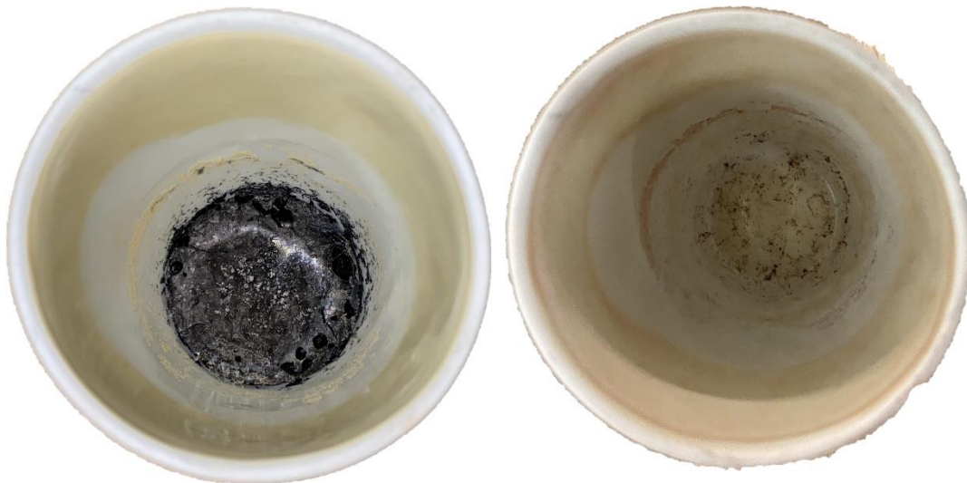
Obr. 40 Kalíšek se zbytkovými popelovinami po vytavení je vlevo (650 °C/20 min), po vyžhání vpravo (1000 °C/20 min).
