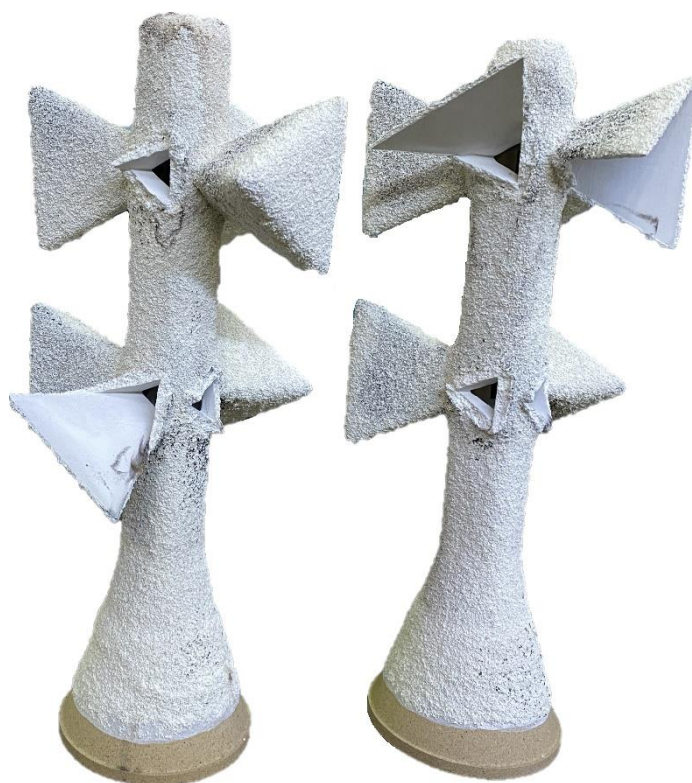
Obr. 27 Dva různé stromečky s rozpraskanou skořepinou v místech, kde byly modely s 0 % výplní, bez odvzdušnění.
