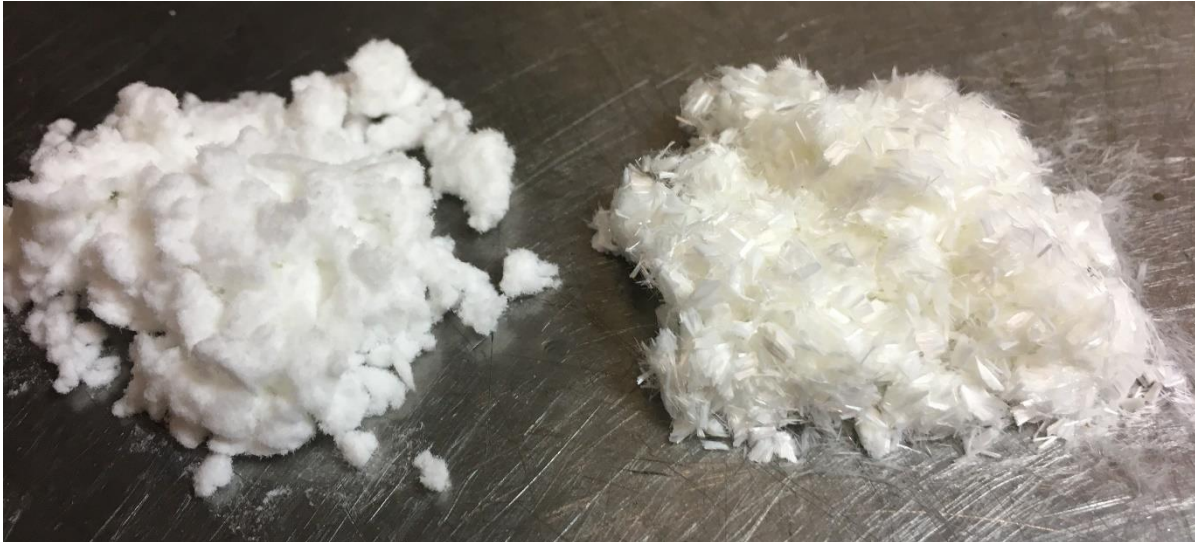
Obr. 19 Struktura nylonových vláken. (vlevo - jemné mletí pro primární suspenzi, vpravo - vlákna do 1,6 mm určená pro zesilovací suspenzi), (Archiv školní slévárny)
