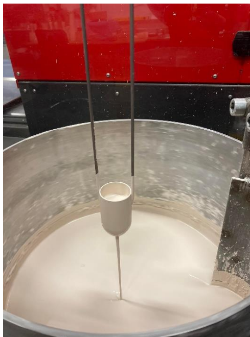
Obr. 21 Měření viskozity, Zahnův pohárek (průměr výtoku 5 mm).
