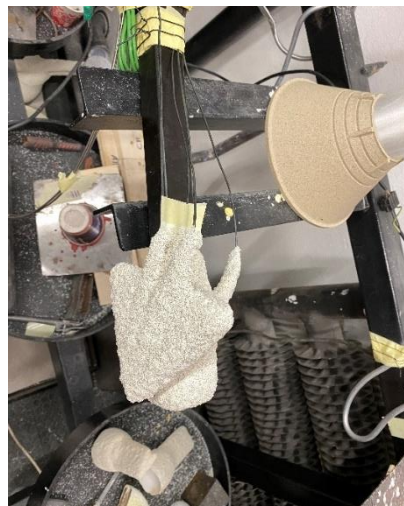
Obr. 54 Sušení kompletně obalené skořepiny.
