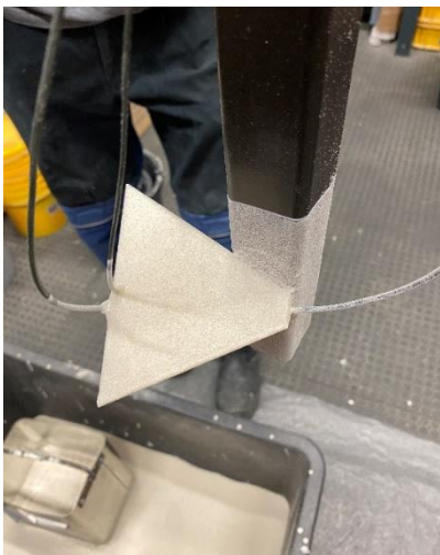
Obr. 51 Primární, zirkonový obal.
