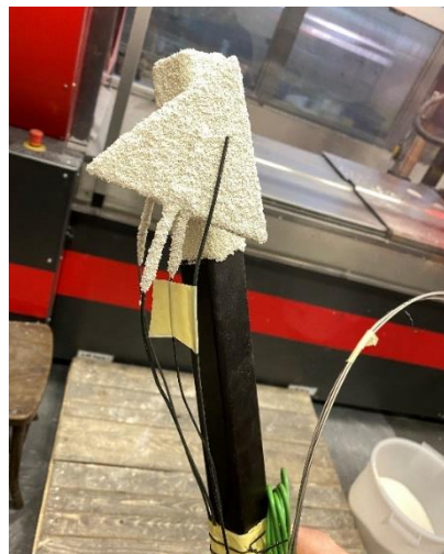
Obr. 52 Termočlánek bude zaobalován uprostřed skořepiny.
