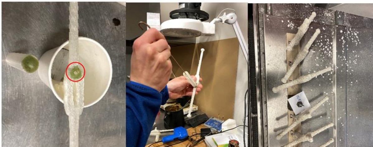
Obr. 67 Propichování rozžhaveným drátem.
