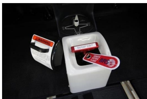
Obr. 26 - Aktivační páka a její umístění v letadle Cessna 182 [46]
