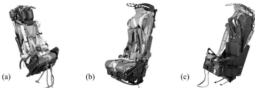
Obr. 3 - Vystřelovací sedadla Martin-Baker; (a) Mk.2; (b) Mk.4; (c) Mk.5 [3] [4] [16]
