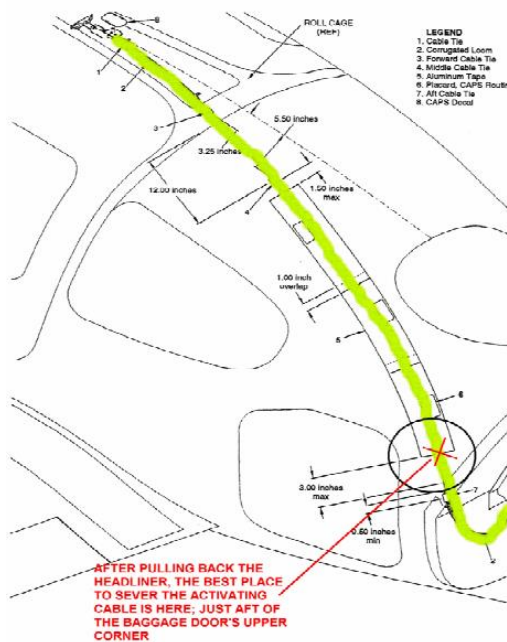
Obr. 32 - Vedení aktivačního lana v letadle Cirrus SR20 a SR22 [42]
