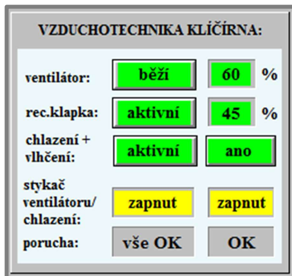
Obr. 47) Zobrazení stavů a hodnot na kontrolním panelu (vzduchotechnika klíčírna).
