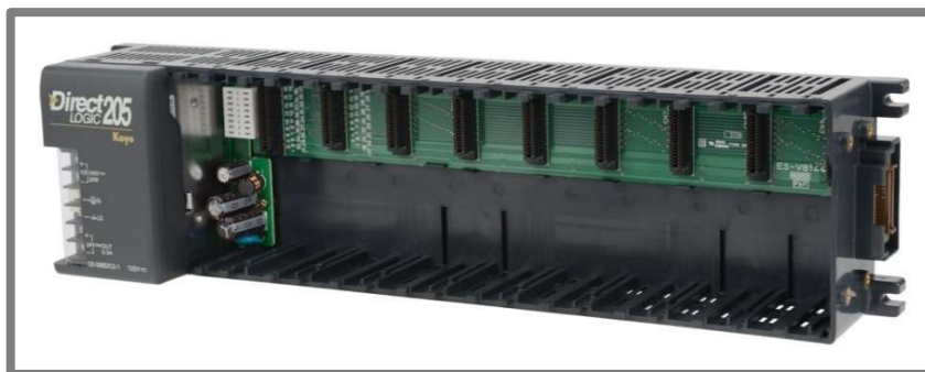
Obr. 16) Ukázka neobsazeného rámu automatu DL205 s 9 volnými pozicemi [31].
