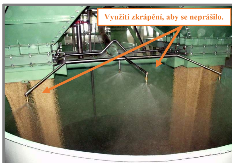
Obr. 3) Převaha ječmene do náduvníku, během technologické operace máčení.
