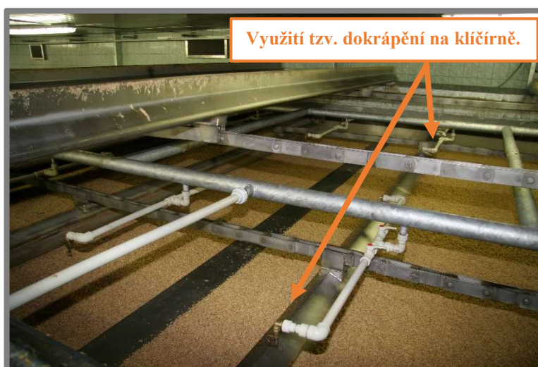
Obr. 5) Dokrácení sladu nad klíčícími skříněmi. Systém je zabudovaný ve speciálním pohyblivém převstrovacím zařízení. [Klíčící skříně ve sladovně Mšeno]
