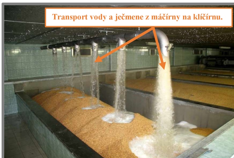
Obr. 4) Využití třetí vody z výrobní etapy máčení pro přepravu sladu do klíčící skříně. [Klíčící skříně ve sladovně Mšeno]
