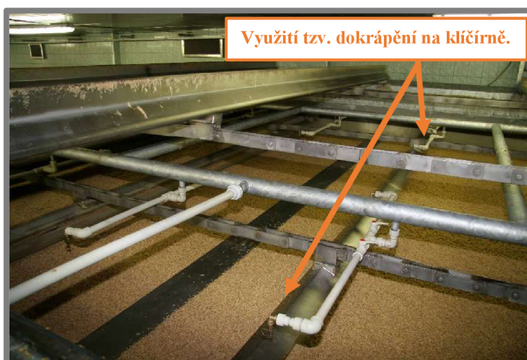
Obr. 5) Dokrápění sladu nad klíčícími skříněmi. Systém je zabudovaný ve speciálním pohyblivém převstrovacím zařízení. [Klíčící skříně ve sladovně Mšeno]
