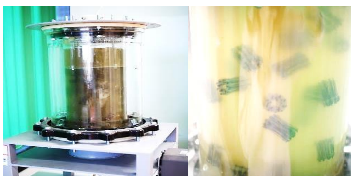
Obr 6: Fotodokumentace laboratorní aplikace ve fluidním reaktoru
