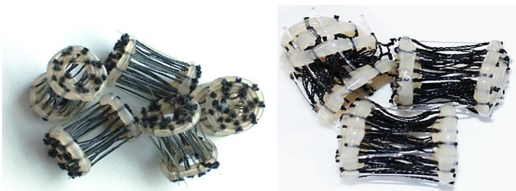
Obr 16: Fotodokumentace soudkovitých nosičů po 2 měsících a po 4 měsících provozu v reaktoru.
