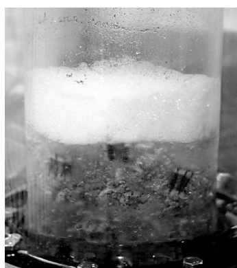
Obr 12: Fotodokumentace pění v reaktoru na počátku měření
