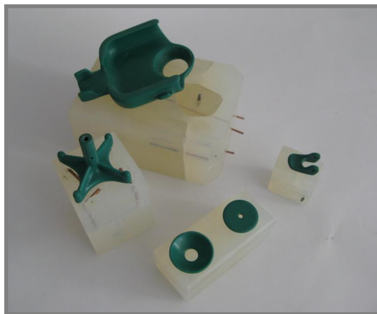
Obr. 6-9 Formy a odlitky vakuového odlévání plastů
