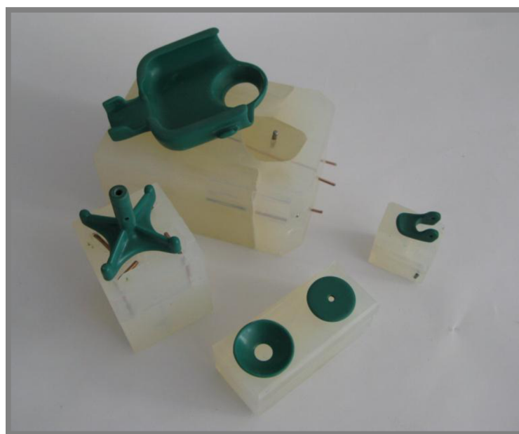
Obr. 6-9 Formy a odlitky vakuového odlévání plastů
