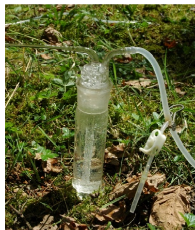
Obr. 8: Voda s vyloučenými bublinkami plynu je přivedena do laboratorní skleněné promývačky. V hrdle promývačky se plyn zachytává a následně je vzorkovací jehlou přepuštěn do vzorkovnice – skleněné víalčky se silikonovým septem.
