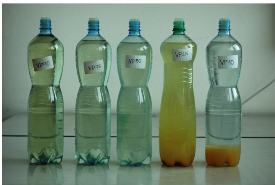
Obr. 12: Reaktory se směsí kyselého zbytkového technologického roztoku z vrtu VP26-6162 s alkalickým neutralizačním činidlem po 1 hodině od míšení. Zleva vzorky VP 90, VP 75, VP 50, VP 25, VP 10.
