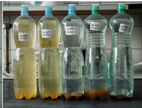
Obr. 11: Reaktorové nádoby se směsí kyselého zbytkového technologického roztoku z vrtu STPC-102 s alkalickým neutralizačním činidlem po 24h od smíšení. Zleva vzorky STPC 90, STPC 75, STPC 50, STPC 25, STPC 10.
