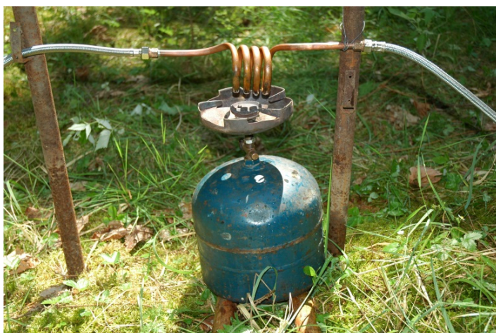
Obr. 7: Čerpaná voda z vrtu se v měděné spirále ohřívá pomocí plynového hořáku. Rozpustnost plynů výrazně klesá s rostoucí teplotou vody a rozpuštěné plyny se z vody vylučují ve formě bublinek.
