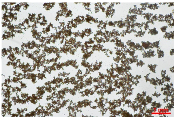
Obr. 41: Vzorek STPC 90 ponořený v matečném roztoku. Mikroskopická metoda: procházející polarizované světlo s polarizátory ||, filtr pro denní světlo, použita clona Abbého kondenzoru 20%, objektiv CFI LU Plan BD 10x/0,30, prac. vzdál. 15,00 mm, zvětšení ~100×
