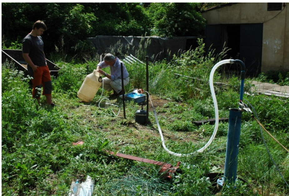
Obr. 6: Celkový pohled na zapojení odběrového zařízení pro vzorkování rozpuštěných plynů.
