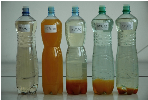
Obr. 10: Reaktory se směsí kyselého zbytkového technologického roztoku z vrtu STPC-102 s alkalickým neutralizačním činidlem po 1 hodině od smíšení. Zleva vzorky STPC 90, STPC 75, STPC 50, STPC 25, STPC 10.
