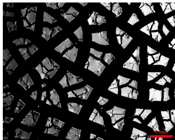
Obr. 47: Vzorek STPC 50 vykazuje základní homogenní matici, v níž jsou vykrytalizované drobné krystaly sádrovce. Snímek ve zpětně odražených elektronech. Velikost měřítka 1 mm.
