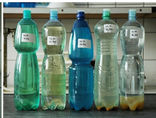
Obr. 13: Reaktorové nádoby se směsí kyselého zbytkového technologického roztoku z vrtu VP26-6162 s alkalickým neutralizačním činidlem po 24h od smíšení. Zleva vzorky VP 90, VP 75, VP 50, VP 25, VP 10.
