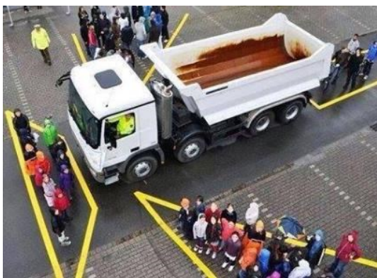
Obrázek 2 – Tzv. „mrtvý úhel“ výhledu řidiče nákladní automobilu, zdroj: převzato z (18)
