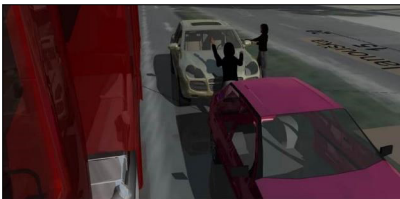
Obrázek 13 – Simulace maximálně možného zakrytého výhledu ve zpětném zrcátku vozidla Tatra, zdroj: převzato z (52).
