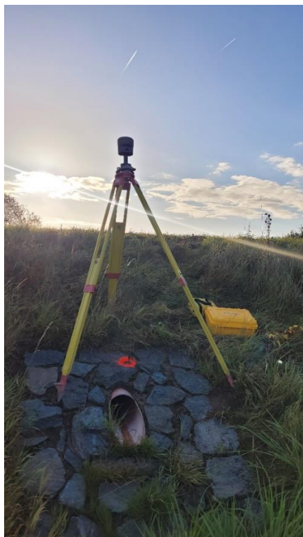
Obrázek 18 R12i - statické měření na bodě 5001 [autor]
