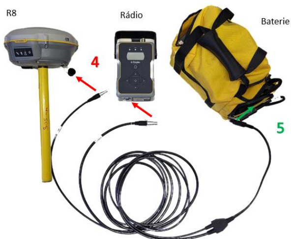
Obrázek 11 Krok č. 4 a 5 spojení GNSS přijímače s rádiem a zapojení baterie [autor]
