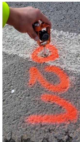
Obrázek 19 Měření polygonového pořadu. [autor]
