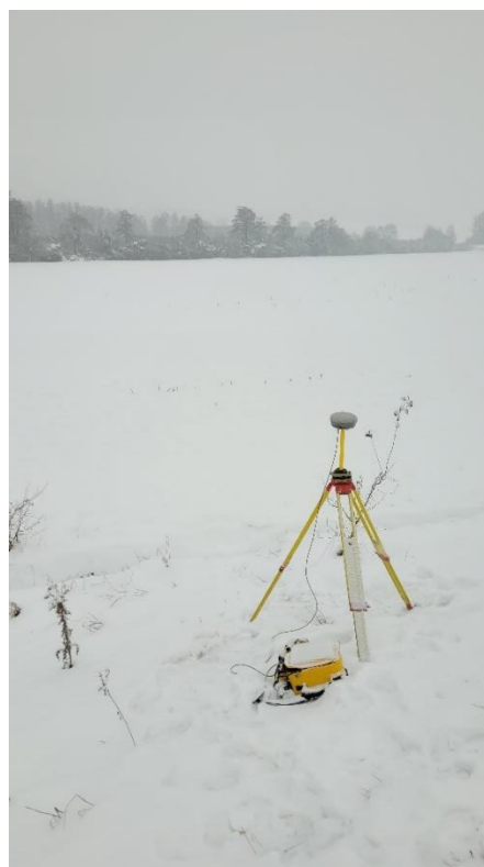
Obrázek 17 R8s - statické měření na bodě 5001 [autor]
