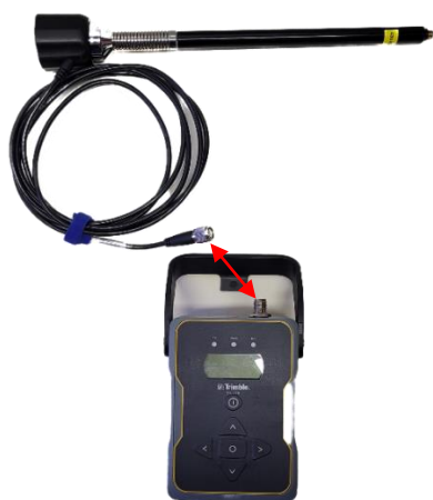
Obrázek 10 Krok č. 3 spojíme anténu s rádiem [autor]
