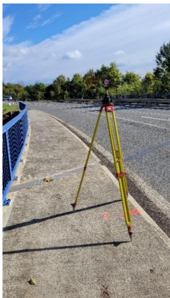
Obrázek 20 Měření polygonového pořadu. [autor]
