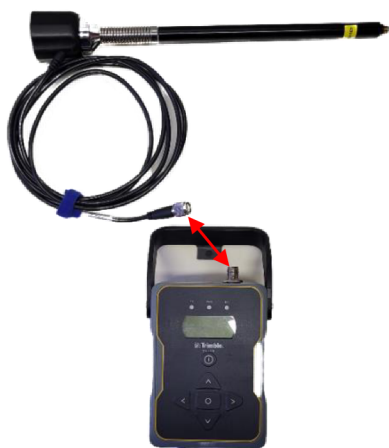
Obrázek 10 Krok č. 3 spojíme anténu s rádiem [autor]
