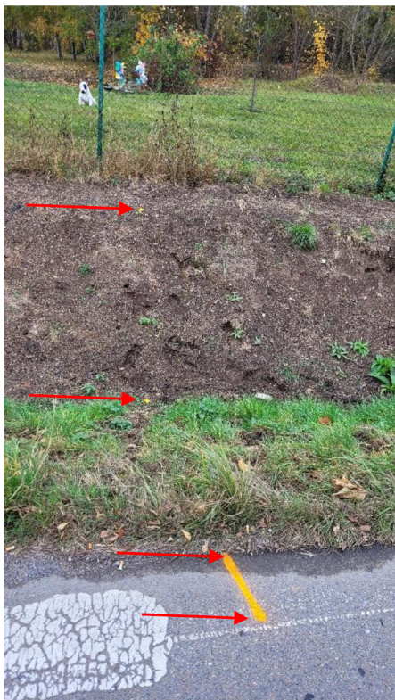
Obrázek 25 Vyznačení profilu na nezpevněné části povrchu [autor]
