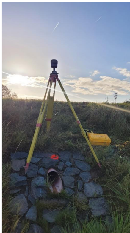
Obrázek 18 R12i - statické měření na bodě 5001 [autor]
