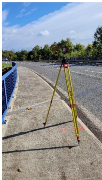
Obrázek 20 Měření polygonového pořadu. [autor]
