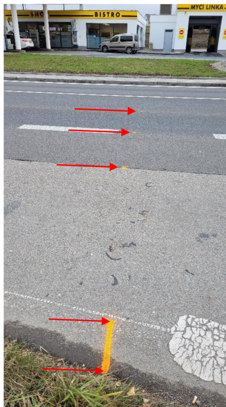
Obrázek 24 Vyznačení profilu na zpevněné části povrchu [autor]
