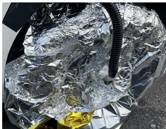
Obr. 18 Zakrytí kola termoizolační fólií (pro účinnější chlazení)
