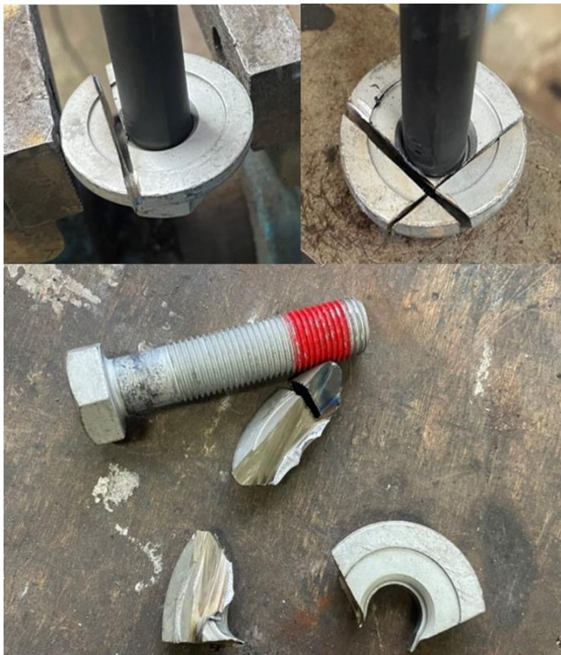
Obr. 12 Sejmutí podložky z originálního šroubu
