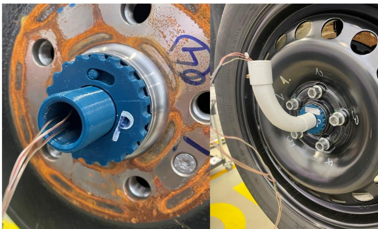
Obr. 14 Montáž měřicí sestavy
