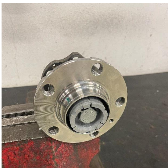
Obr. 6 Zástavbová zkouška (PLA, 3D tisk)
