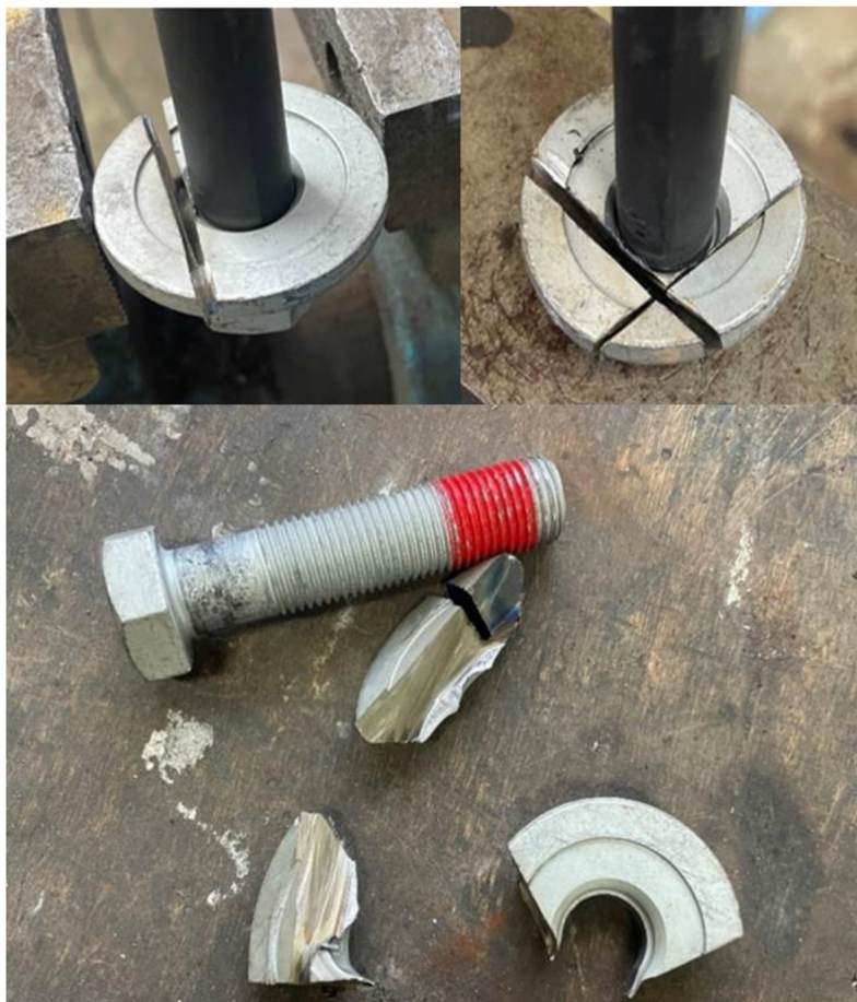
Obr. 12 Sejmutí podložky z originálního šroubu
