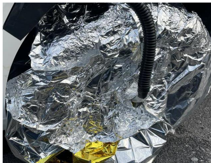
Obr. 18 Zakrytí kola termoizolační fólií (pro účinnější chlazení)
