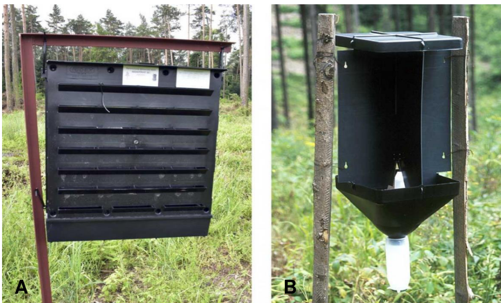
Obrázek 7 Feromonové lapače. A - štěrbinový lapač; B - křížový lapač (Agromanual.cz, 2023)
