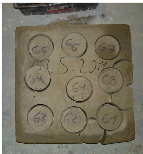
Obrázek 19: provádění jádrových vývrtů ze zkušební desky pro výrobu zkušebních těles
