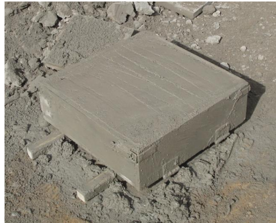
Obrázek 17: upravená forma po provedení nástřiku
