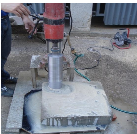
Obrázek 19: provádění jádrových vývrtů ze zkušební desky pro výrobu zkušebních těles
