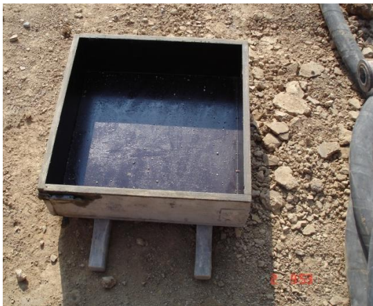
Obrázek 16: forma opatřena separačním přípravkem
