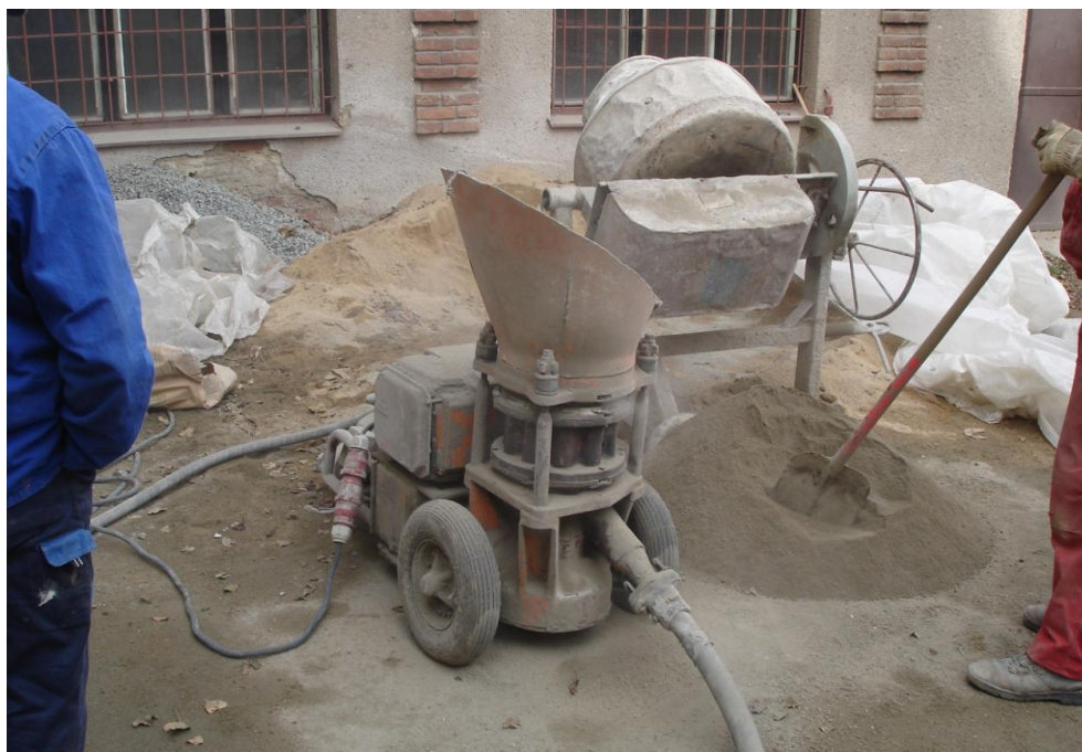
Obrázek 34: strojní zařízení pro realizaci nástřiku suchou cestu
